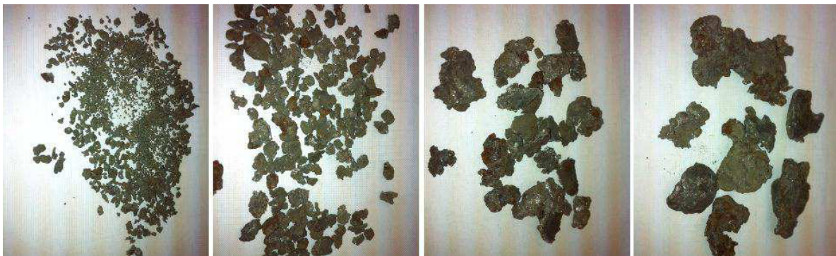
Photo.51-16 スタンプ検定で回収した粒度毎金属鉄(左から-0.5~3.5mm,3.5~8mm,8~15mm,15~50mm)
