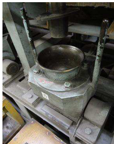
Photo.6-2 スタンプミル
