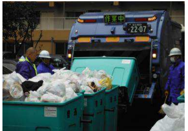
写真 5-10-45 屋根付保管場所(東京・品川区) 写真 5-10-46 コンテナを反転させ油圧で積込
