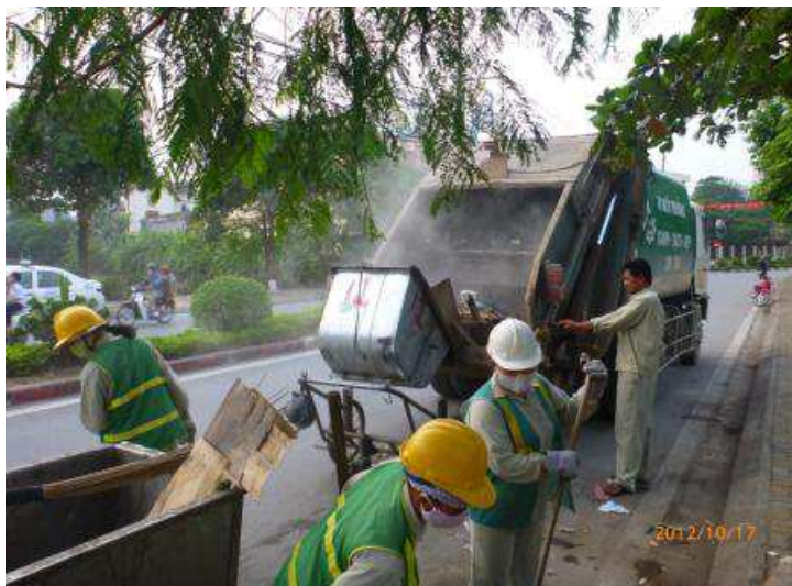
写真 5-10-30 ハンドカートの容器を本体から分離し反転投入
