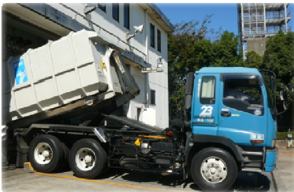
写真 5-10-17 アームロール車への積み替え作業
