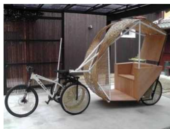
廃竹材を利用した観光用力車の製作
