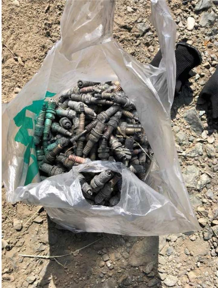
図 43 鉄スクラップ向け資源からのピックアップした着火プラグ
