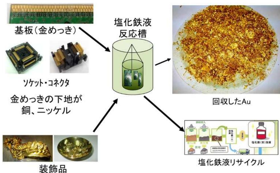
図 7 塩化鉄 ( ) を使用した貴金属の回収
