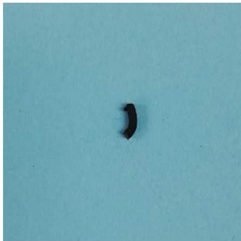
図 52 分離後の外側電極部分
