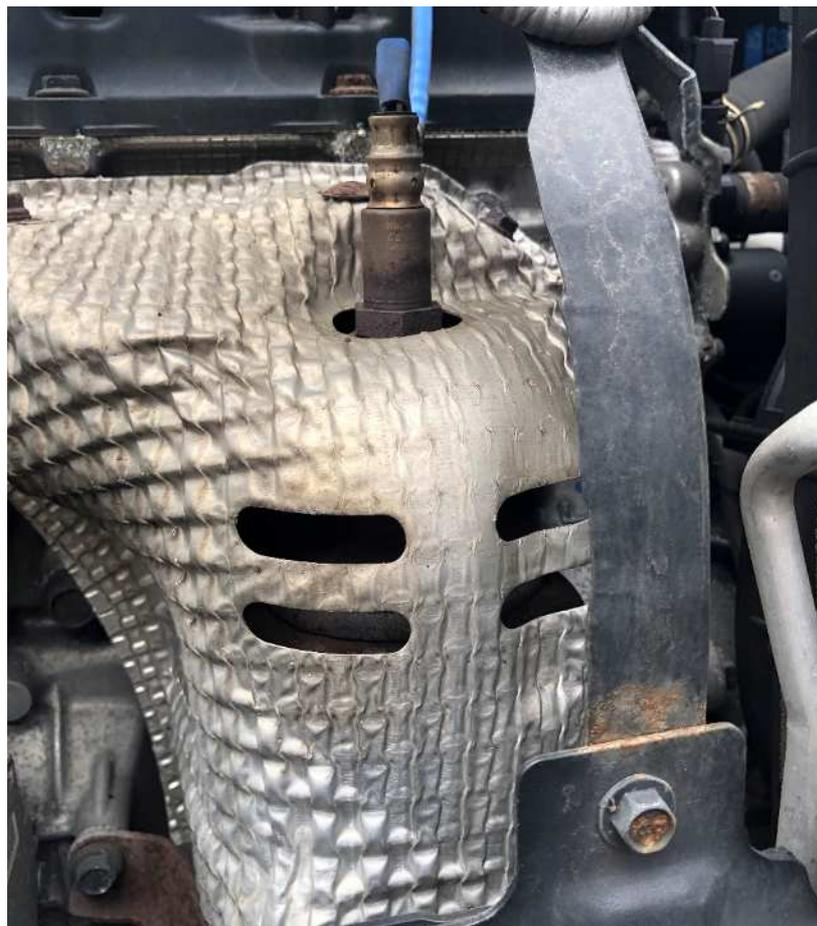
図 31 O2 センサー設置個所の拡大写真
