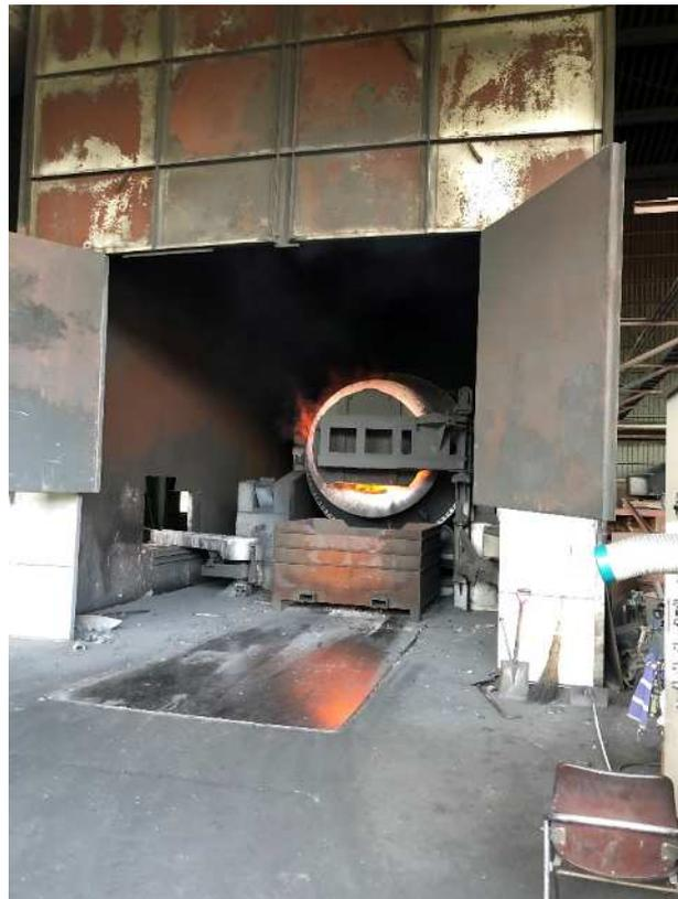
図 40 エンジンのアルミ溶解炉
