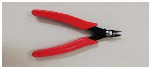
図 49 中心電極の分離に使用した線材用ニッパー
