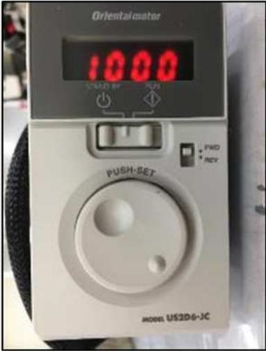
図 19 ベルトコンベア コントローラ
