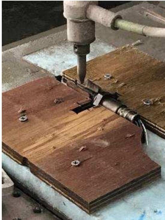
図 55 ウォータージェットの切断風景
