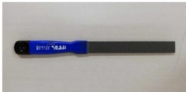
図 47 中心電極の分離に使用したステンレス用ヤスリ
