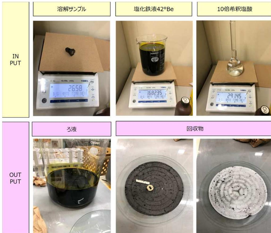
図 56 塩化鉄による溶解実験
