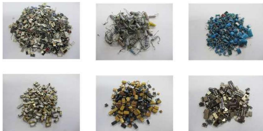
図 4 蒸気分離後の電子部品
