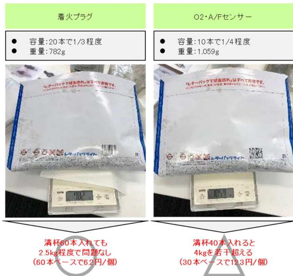
図 38 着火プラグと O<sub>2</sub> センサーのレターバックライトでの回収の検討結果
