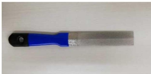
図 48 中心電極の分離に使用したダイヤモンドヤスリ
