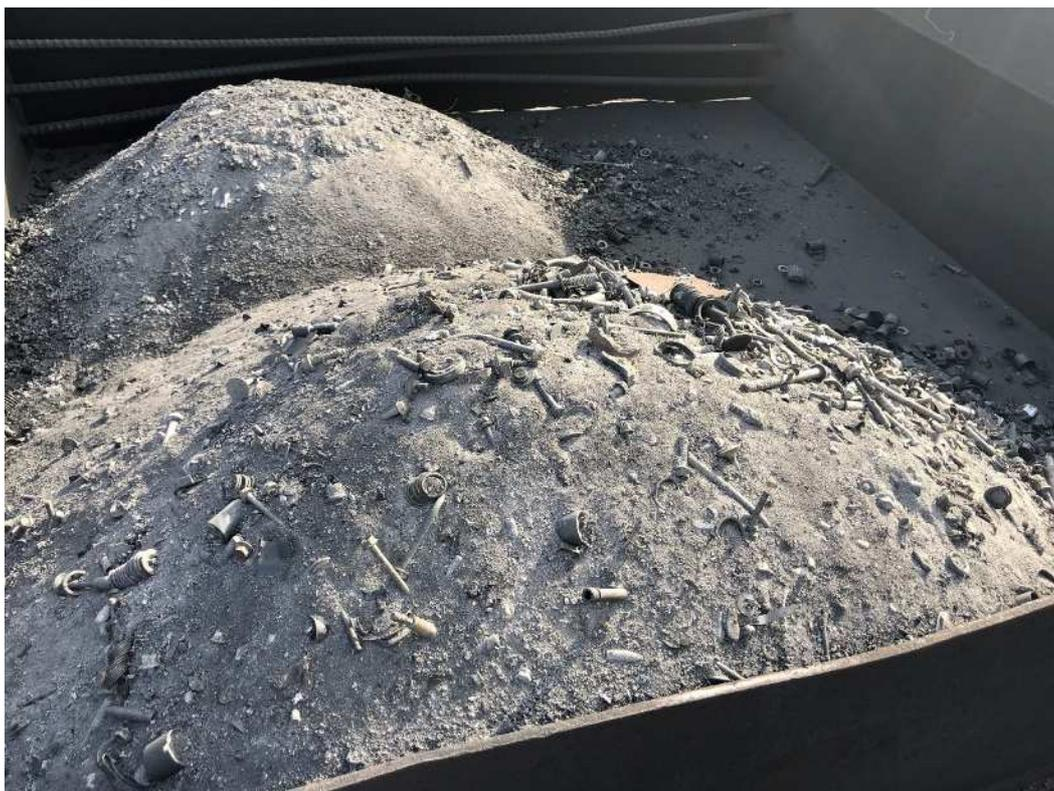
図 41 溶解炉から出てくる残渣
