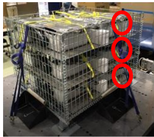
図 3-21 供試品の板金がメッシュパレットに接触(後方より撮影)
