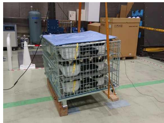
図 3-16 2-3/3-4 底稜の落下試験 (供試品バンド固定あり)
