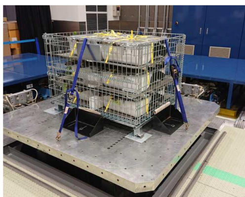
図 3-9 振動試験の測定環境 (供試品バンド固定あり)
