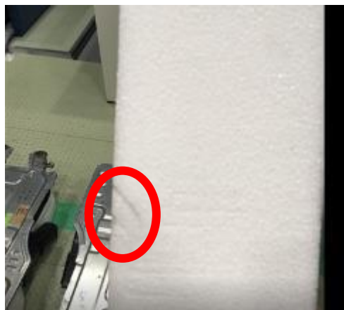
図 3-24 緩衝材の凹み
