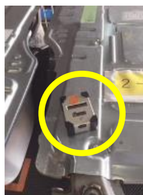
図 3-79 上段のロガーのズレの状況
