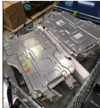
図 3-28 振動試験中に供試品(バンド固定なし)が時計回りに移動(上面より撮影)
