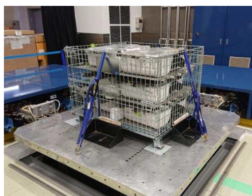
図 3-10 振動試験の測定環境 (供試品バンド固定なし)
