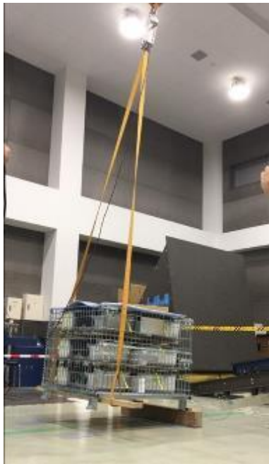
図 3-11 片支持自由落下試験の吊り上げ状況(供試品バンド固定あり)
