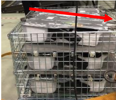
図 3-38 メッシュパレットへの噛みこみ(バンド固定なし)
