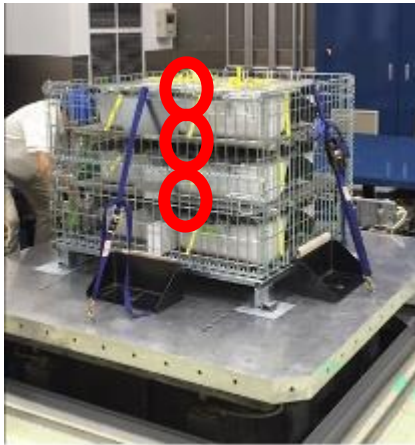
図 3-20 供試品の板金がメッシュパレットに接触(前方より撮影)
