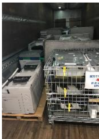
図 3-63 復路における複写機と LiB パックのメッシュパレットとの混載
