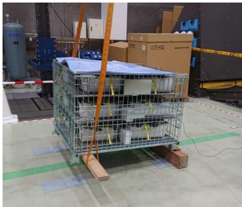
図 3-15 3-5/3-6 底稜の落下試験 (供試品バンド固定あり)
