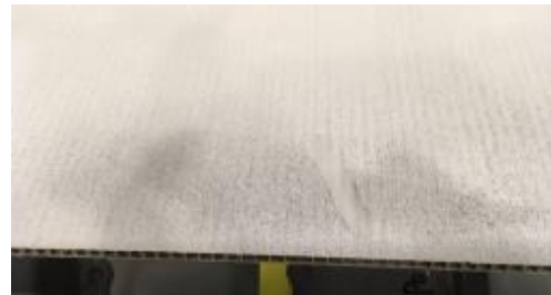
図 3-23 メッシュパレットが削れた鉄粉が付着した仕切り板
