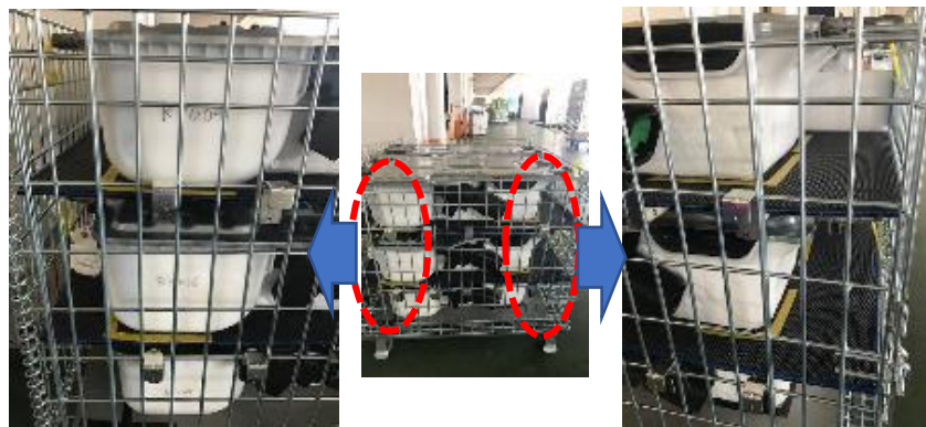
図 3-58 往路の着荷時の LiB パックのズレ(左側面)
