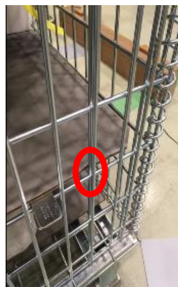
図 3-32 仕切り板の凹み(メッシュパレットへのめり込み)
