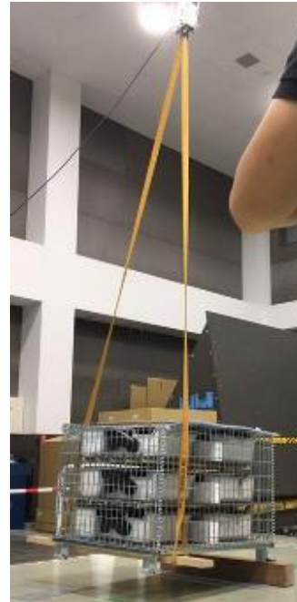
図 3-12 片支持自由落下試験の吊り上げ状況(供試品バンド固定なし)
