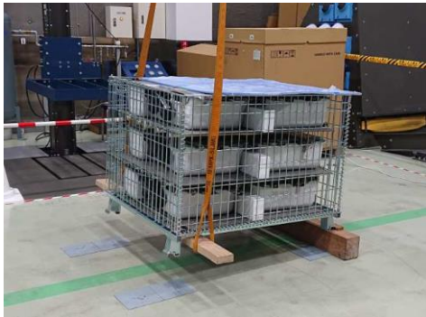
図 3-17 3-5/3-6 底稜の落下試験 (供試品バンド固定なし)
