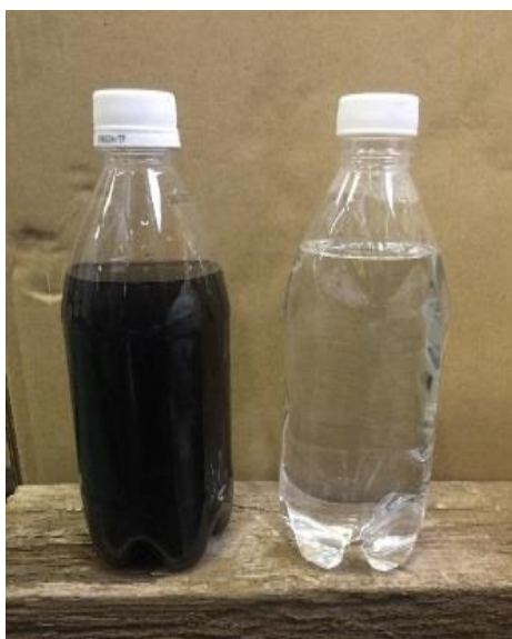
図 2.2.28 活物質を含む原液 (左) とろ過水 (右)
