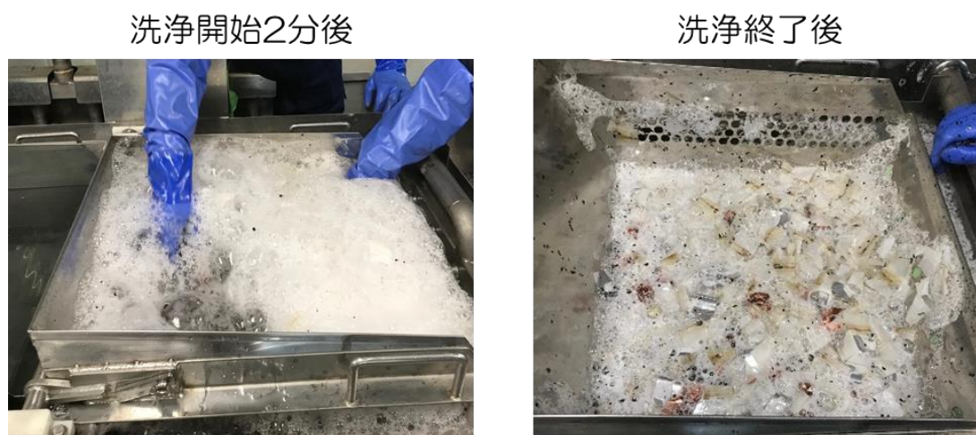
図 2.3.18 水流分別時（試験 3）の発泡の様子
