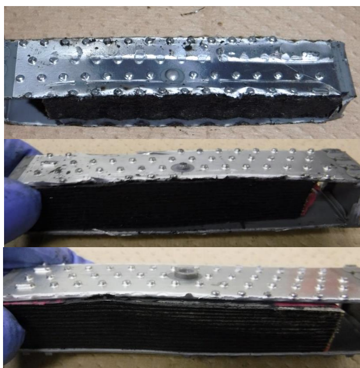
図 2.2.18 鋸刃(上)、波刃(中)、ストレート刃(下)で切断した様子
