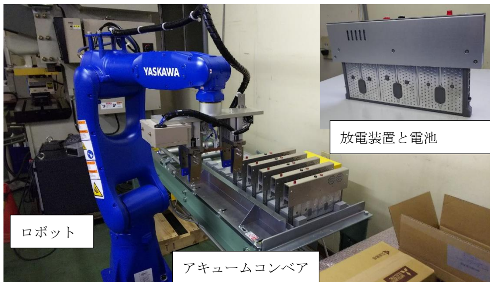
図 2.2.6 試作した放電装置と自動取出装置
