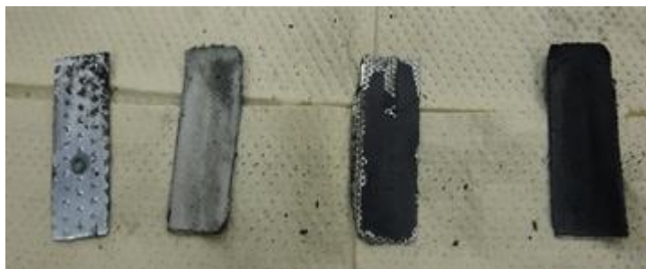
図 2.2.22 プレス金型で打ち抜いた電極部
