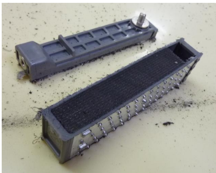
図 2.2.15 丸鋸刃で切断した後の電池の様子
