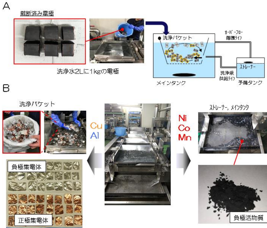
図 S2.3.1 裁断済みリチウムイオン電池電極の水流分別法
