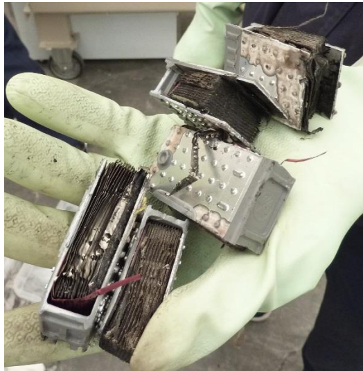
図 2.2.17 電極部中央のみを切断した場合の水流分解後の様子
