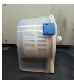
図 2.3.12 電極部材の洗浄による電解液の除去
