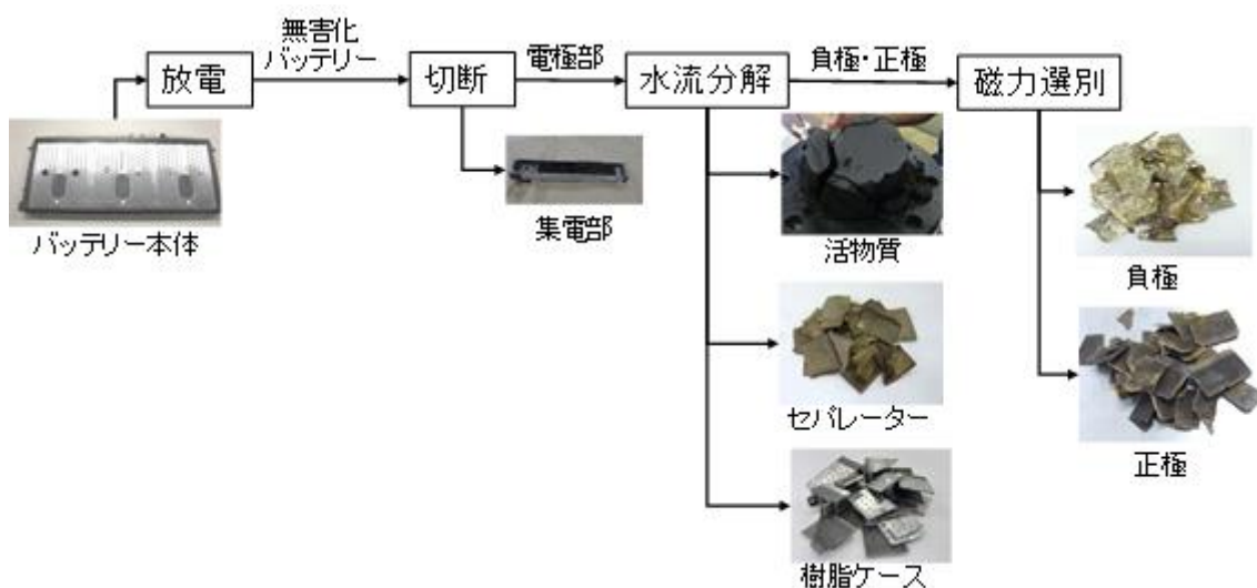
図 2.2.2 焼却を伴わない電池リサイクルプロセスフロー
