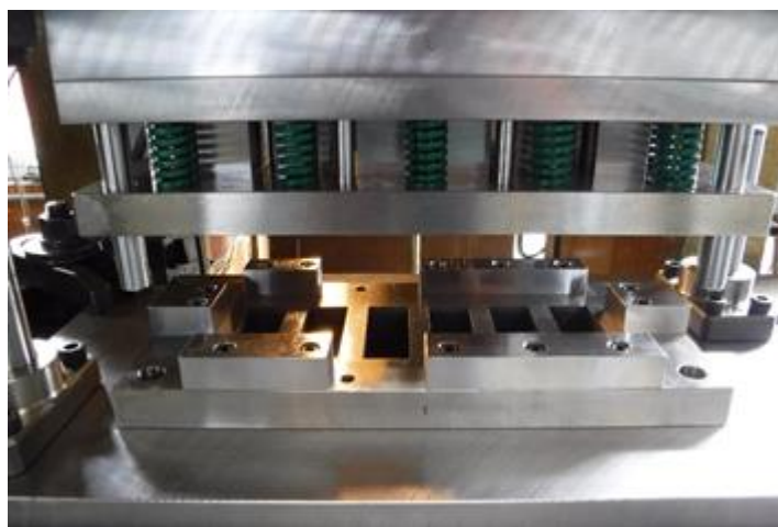
図 2.2.21 電池の電極部を 6 箇所同時抜きするための金型
