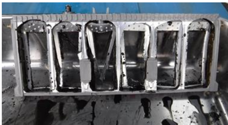
図 2.2.23 プレス金型で打ち抜いた後の集電部を含むフレーム
