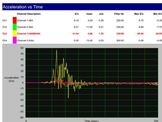
図 3-10 落下衝撃 底面
