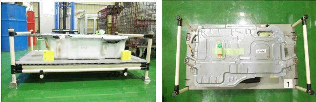
図 3-5 イレクターパイプ式循環ラック+ダミー電池パック
