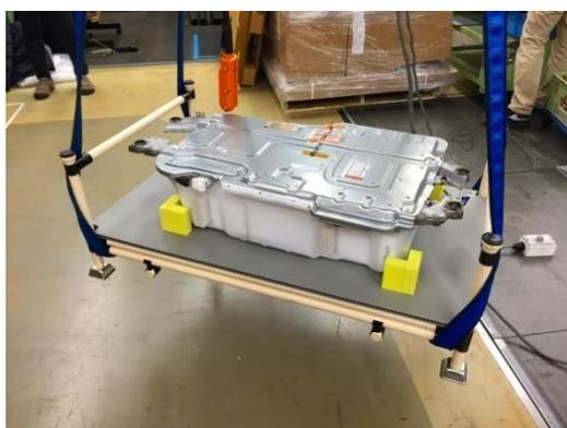
写真 3-9 3 面方向の落下試験
