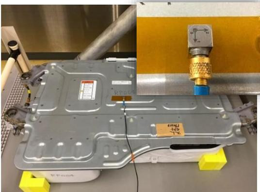
写真 3-7 加速度ピックアップ取り付け
