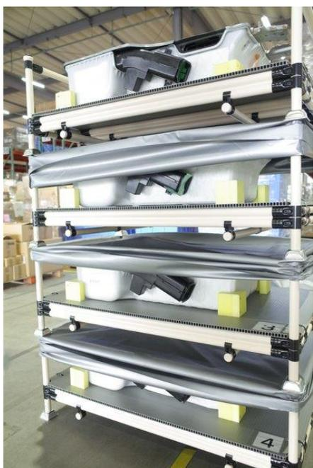
写真 3-14 【A】イレクターパイプ 4 段積
