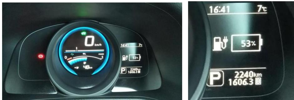
図 4-19 EV のメーターによる残容量確認
