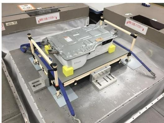
写真 3-1 ランダム振動試験(ベルトあり)
