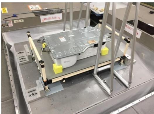
写真 3-3 跳ね上げ振動試験(ベルトあり)
