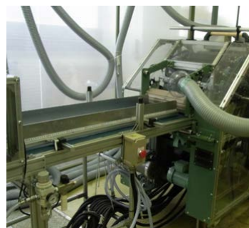
カード機(二次解繊)：東亜ノウヴェンマシナリー(株) M18S-400 型 (フィードローラー(供給)速度 0.5rpm、ドファ(送出)速度 5.0rpm)
