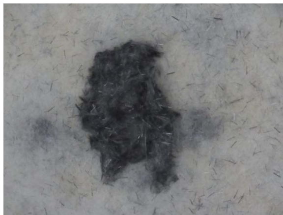
図 4-14.溜まった CF を引き込んだ状態の中間基材
