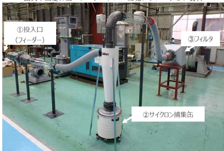
図 3-4.サイクロンの試験装置全体像
