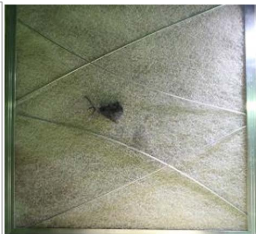
実験後フィルター前段 (CF 50mm, 8m/s)
