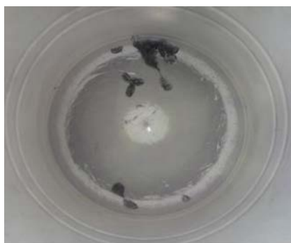
実験後のサイクロン捕集缶（CF 12mm, 8m/s）
