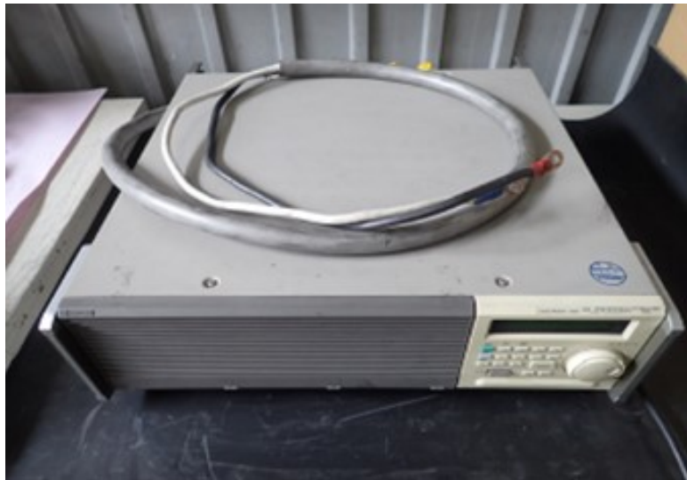
図 1.2-6 モジュールの放電に用いた電子負荷装置 (PLZ1003W)
