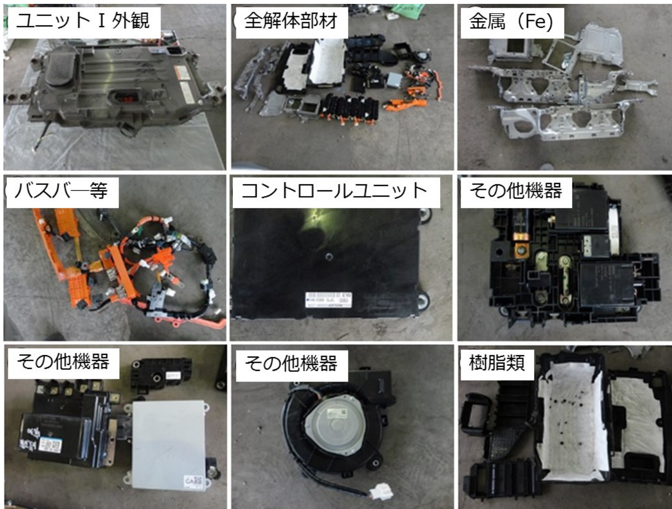
図 1.2-2 LIB ユニット解体試験結果の 1 例 (LIB ユニット : I)
