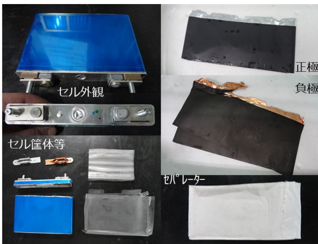
図 1.2-4 セル①の分解試験 (分解時の状況)
