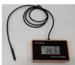
①Ontrasys Tag、②輸送対象物表面温度測定用
