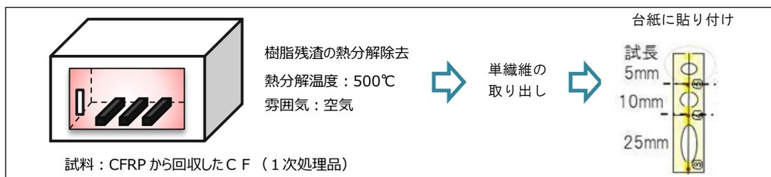
図 3-14. 1 次処理 CF 単繊維強度測定のためのサンプル調製手順
