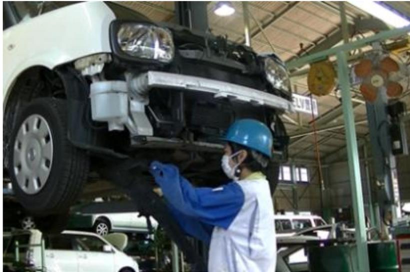
◆車体位置を高くすることで作業スペースが確保され回収時間が短縮、作業場所の移動も少なく、移動・運搬時間も短縮されている（写真はキューブ）
