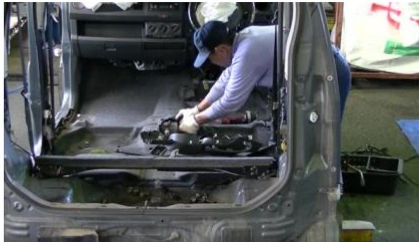
◆事前に周辺部品を取り外して作業スペースを確保し、回収時間を短縮している（写真はワゴンR）
