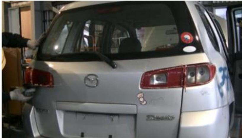
◆カッターを水平に移動させ、同じ方向から先に切り出すことで移動・運搬時間を短縮（写真はデミオ）
