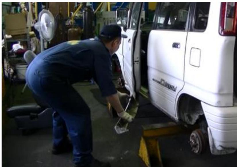
◆工具を使用せず取り外しを行うことで、解体時間、移動・運搬時間を短縮している（写真はムーヴ）
