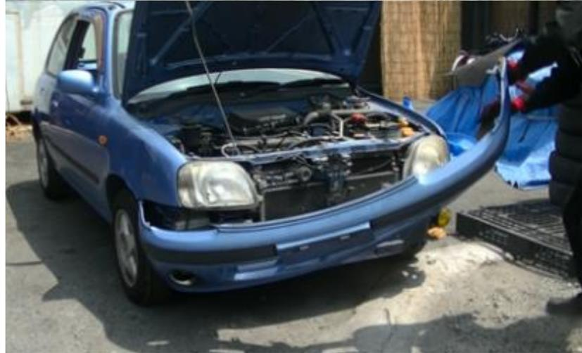
◆工具を使用せず取り外しを行うことで、解体時間、移動・運搬時間を短縮している（写真はマーチ）
