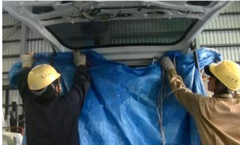
◆リアゲートダンパーにブルーシートを挟み、リアドアを包み込むようすることでガラスの飛散を防ぐとともに、破碎したガラスを回収しやすくし移動・運搬の時間を短縮している（写真はステップワゴン）
