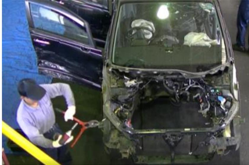
◆事前に周辺部品を取り外して作業スペースを確保、必要な工具を事前に準備してから解体し、移動・運搬時間を短縮している（写真はオデッセイ）
