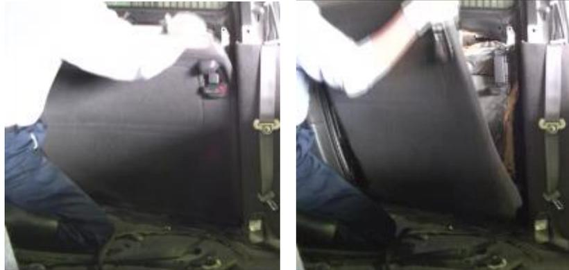
◆工具を使用せず取り外すことで、工具の持ち替えに伴う移動・運搬の時間を短縮（写真はステップワゴン）
