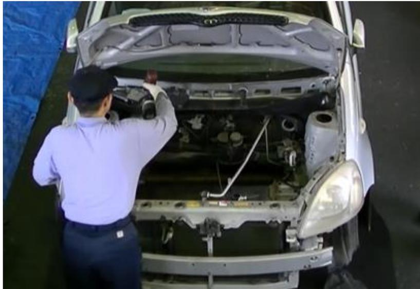
◆事前に周辺部品を取り外して作業スペースを確保しておくことで解体を容易にし、時間を短縮している（写真はキューブ）
