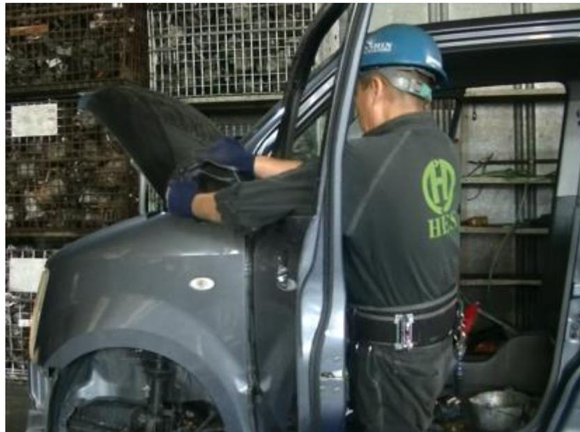
◆ウィンドウを下げておく等作業スペースを確保し、作業場所の移動を最小限にすることで、移動・運搬の時間を短縮（写真はワゴンR）
