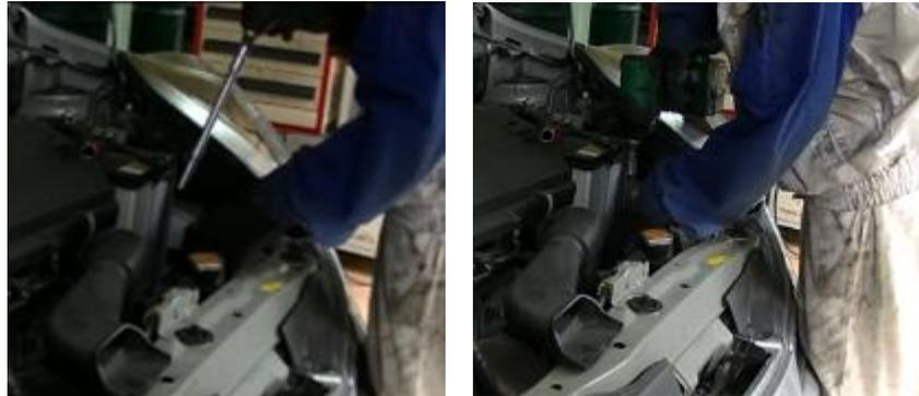
◆手の届きにくい場所に設置したヒューズボックスをロングタイプのドリルビットで取り外し、回収時間を短縮している（写真はマーチ）
