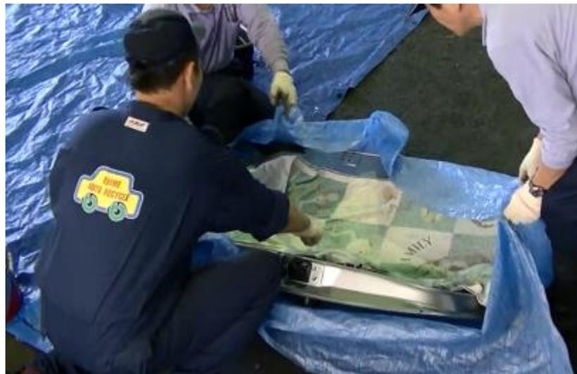
◆ガラス部をタオルで覆い、安全に作業を行うとともに、飛散を防いで破碎したガラスを回収しやすくし移動・運搬の時間を短縮している（写真はヴィッツ）
