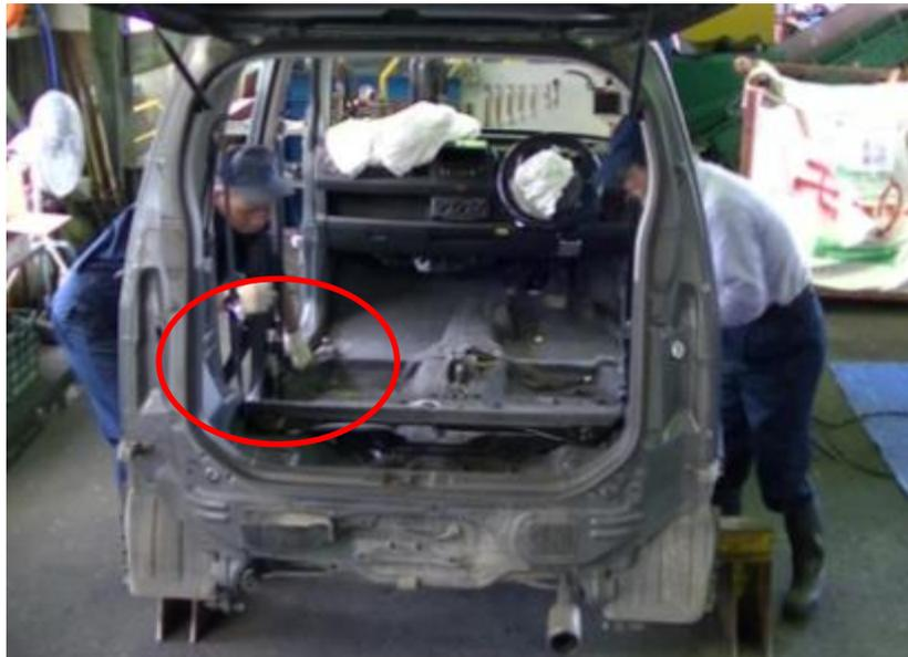
◆作業場所の確保を行うことで、1人で2ヶ所同時に取り外しを実施、移動・運搬にかかる時間を短縮（写真はワゴンR）
