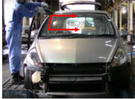
◆足場を使用することで一度に手が届く作業範囲が広がり、回収時間が短縮されている。また、作業範囲が広がることで移動しながら切断を行う必要がなく、安全で効率的に解体されている（写真はフィット）
