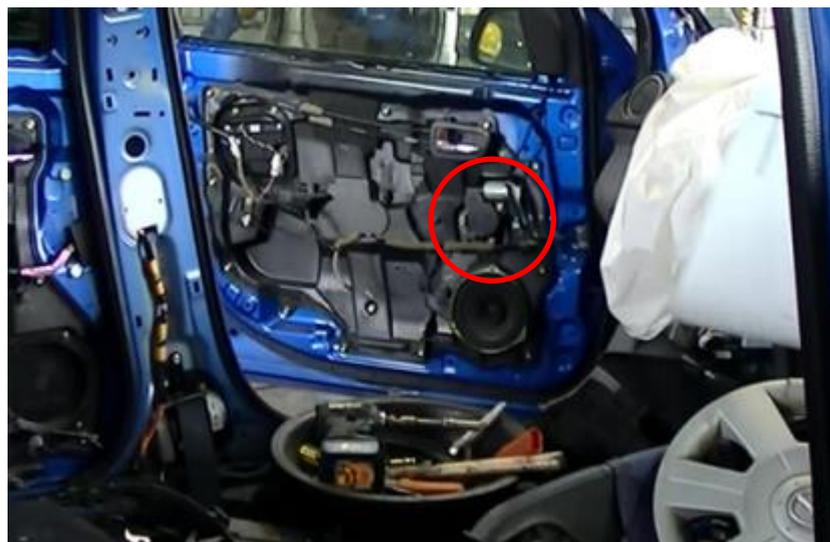
◆事前に周辺部品（ドアトリム）を取り外して作業スペースを確保し、回収時間を短縮している。また、モーターの取り外しにウィンドウが干渉しない場合は、回収時間が短縮される（写真はともにデミオ）
