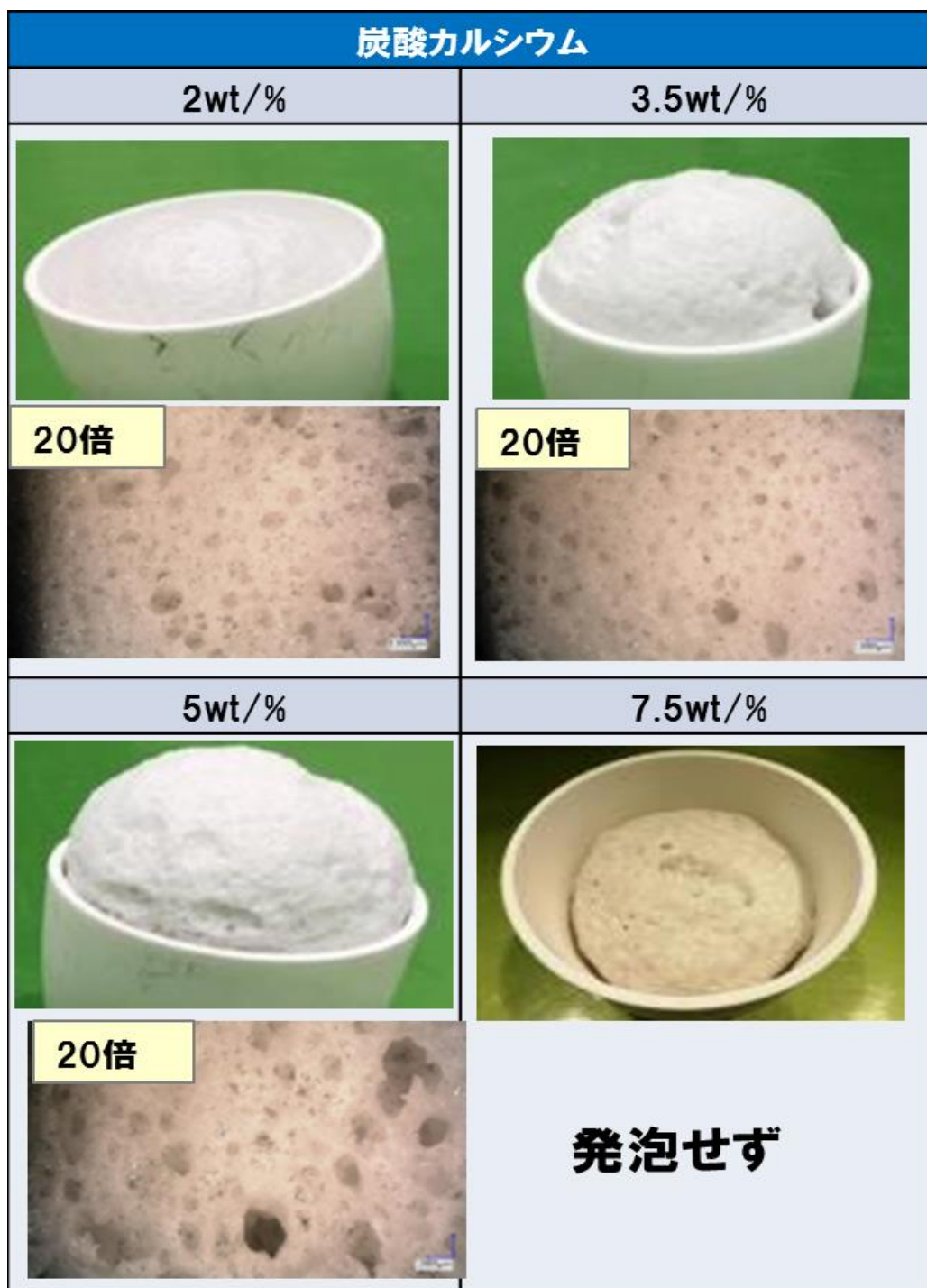
図 5-12 : 炭酸カルシウム添加量を変えた発泡ガラス写真
