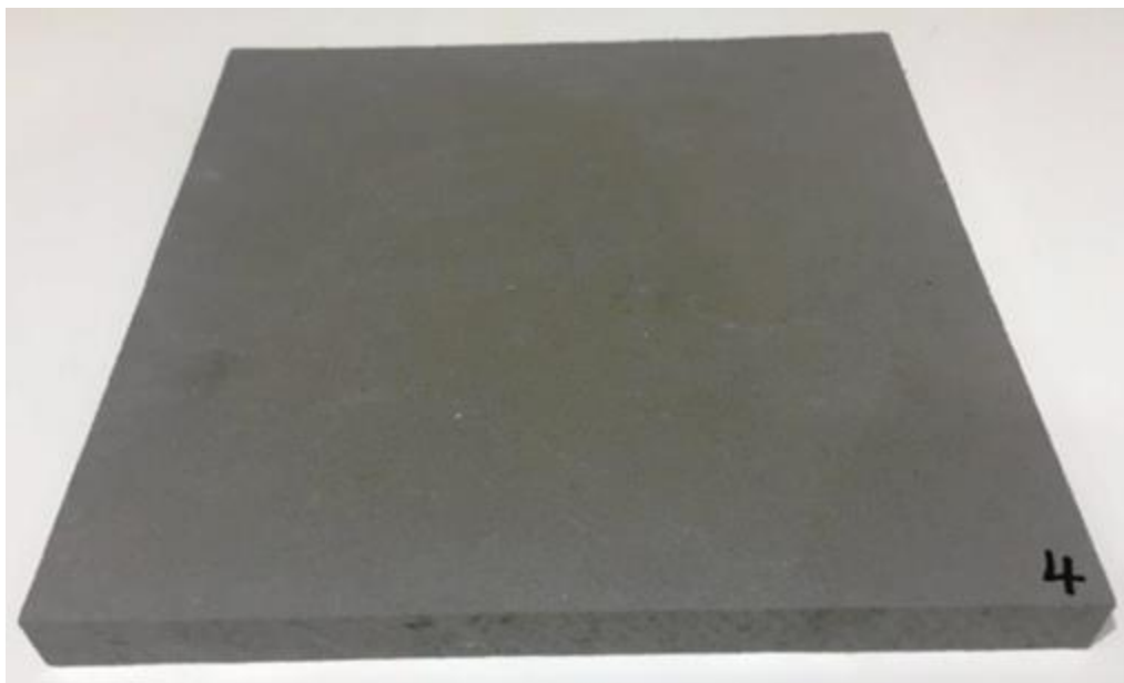
図 5-7：発泡ガラス添加外壁材写真
