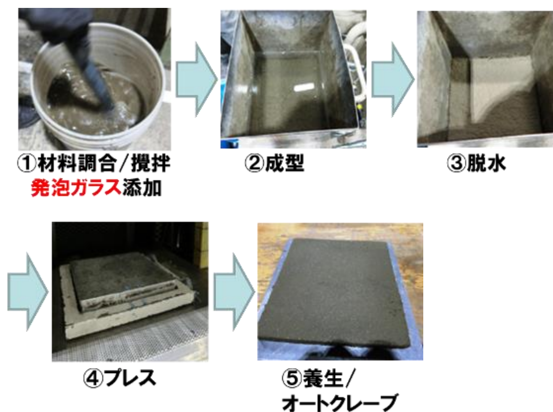
図 5-6 : 外壁材製造フロー
