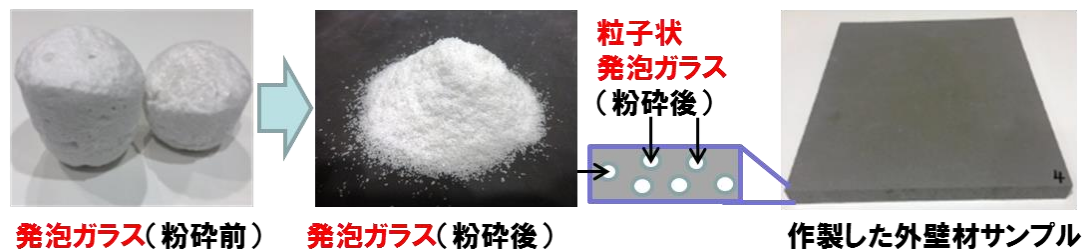
図 5-1 : ガラス再生工程の検証概要
