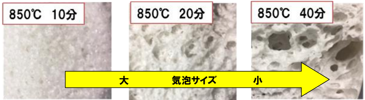
図 5-11 : 各加熱時間の発泡ガラスの断面写真
