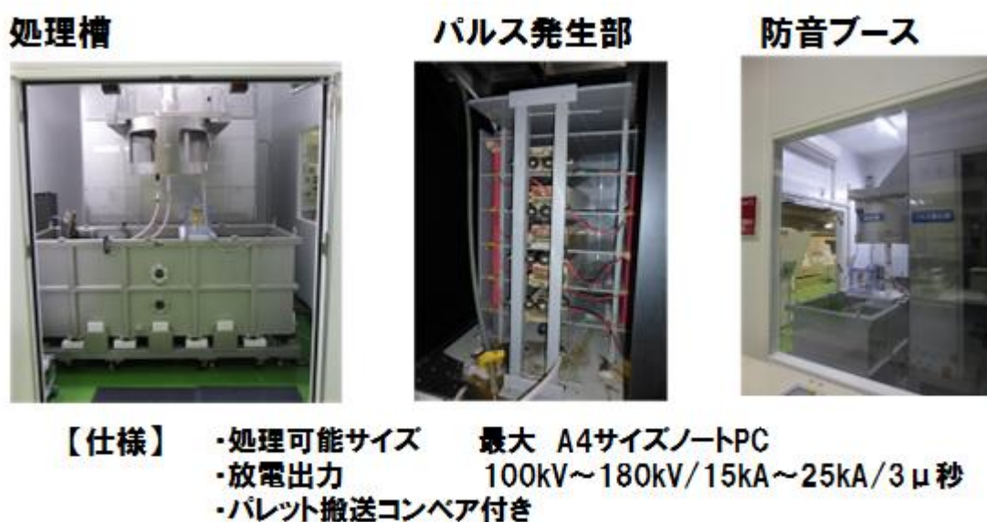
図3-1：自社開発マルクス式パルス破碎装置
