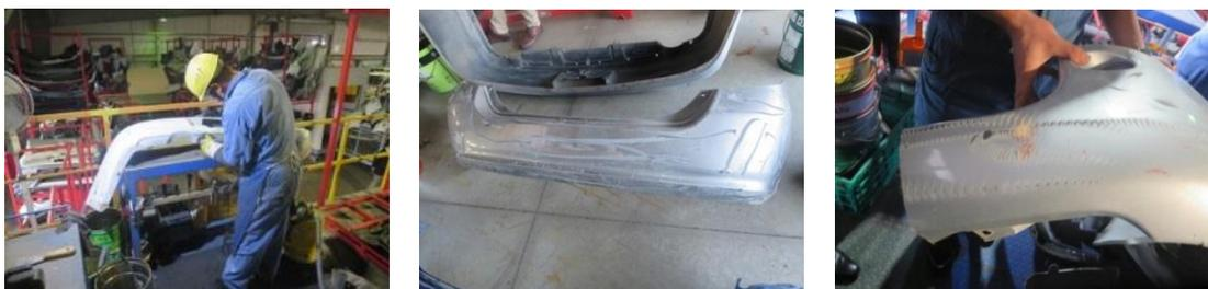
図 2-10 パテ除去作業工程（左）と確認後のバンパー（中）、パテ使用品（右）
