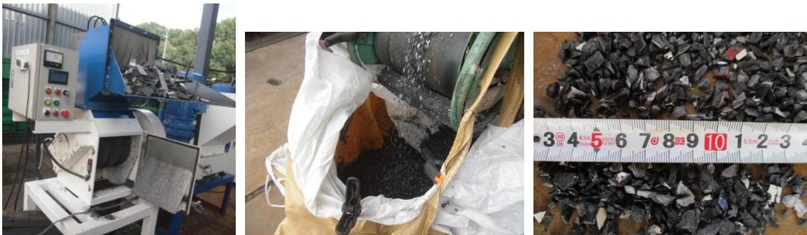
図 3-3 粉砕工程と処理後の破砕材
