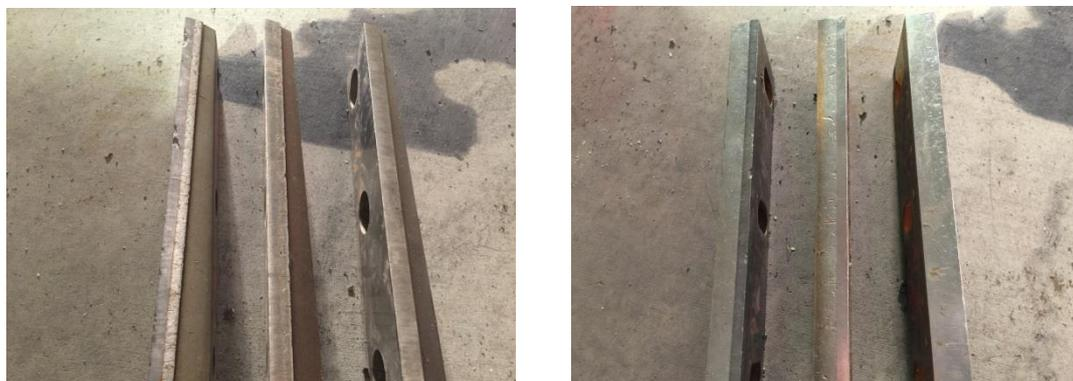
図 4-2 回転刃（右）と固定刃（左）試験後比較（左：超硬、中：ハイス鋼、右：ダイス鋼）
