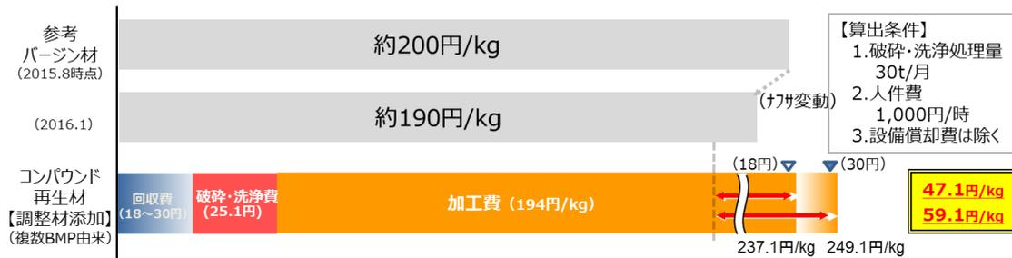
図 7-3 平成 27 年度事業のバージン材とのコスト比較（アンダーカバー向け材料）
