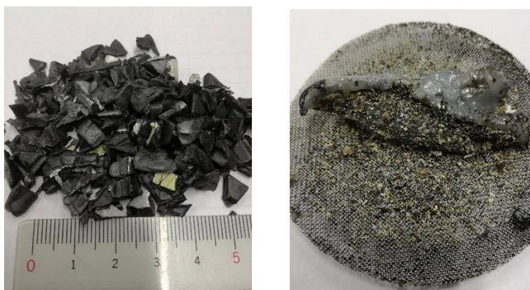
図 2-14 破碎材外観と熔融処理後のスクリーン
