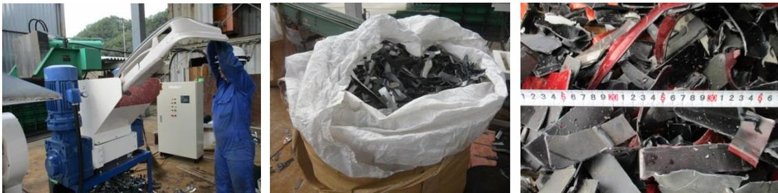
図 3-2 粗破砕工程と処理後の破砕材
