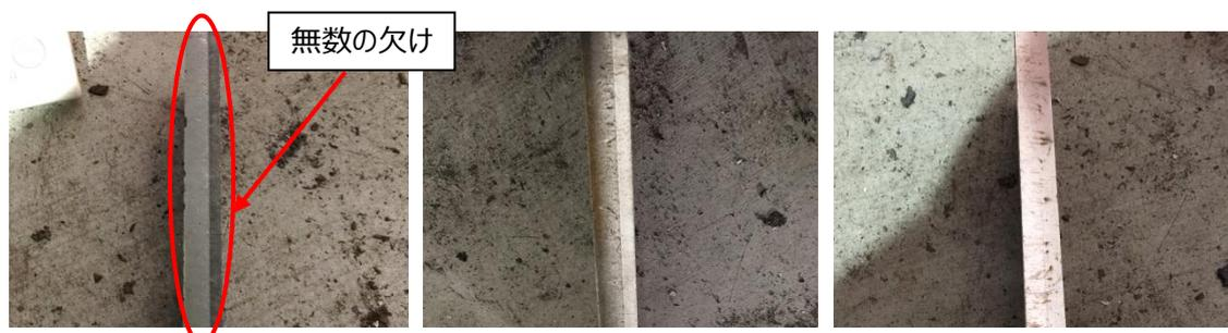
図 7-2 【再掲】固定刃に設置した刃物（左：超硬、中：ハイス鋼、右：ダイス鋼）
