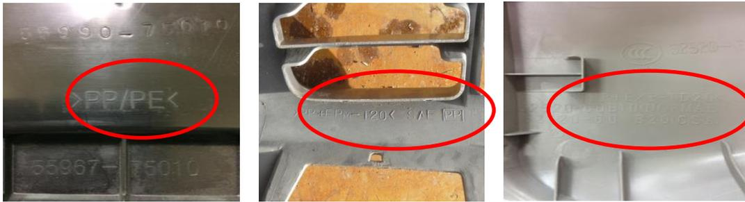
図 2-5 PP 部品に刻印されている PP 素材表示
