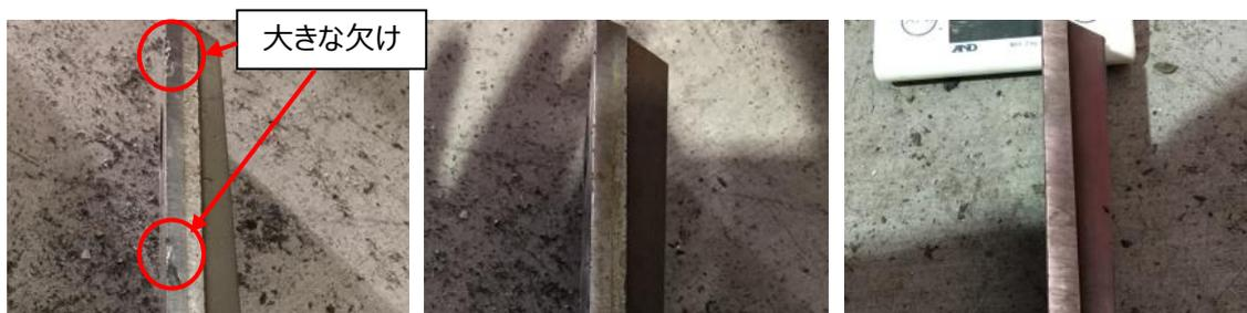
図 7-1 【再掲】回転刃に設置した刃物（左：超硬、中：ハイス鋼、右：ダイス鋼）
