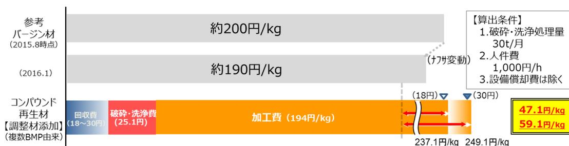
図 1-1 平成 27 年度事業におけるバージン材と再生材グレードのコスト比較
