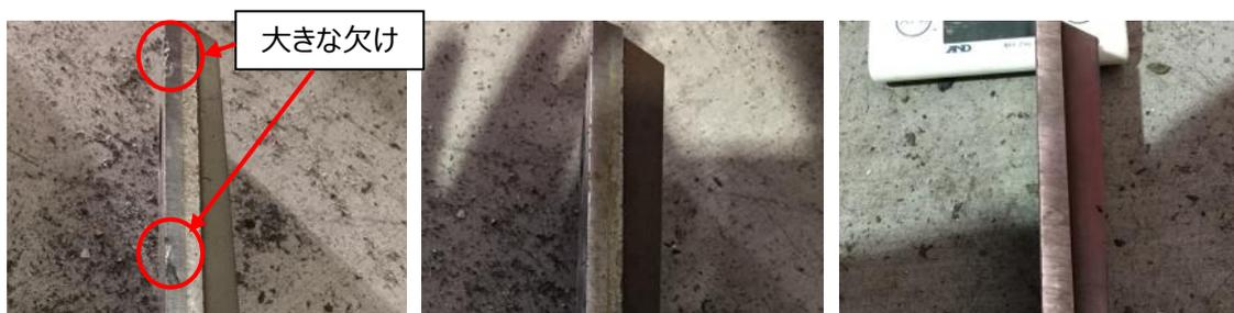
図 2-12 回転刃に設置した刃物（左：超硬、中：ハイス鋼、右：ダイス鋼）
