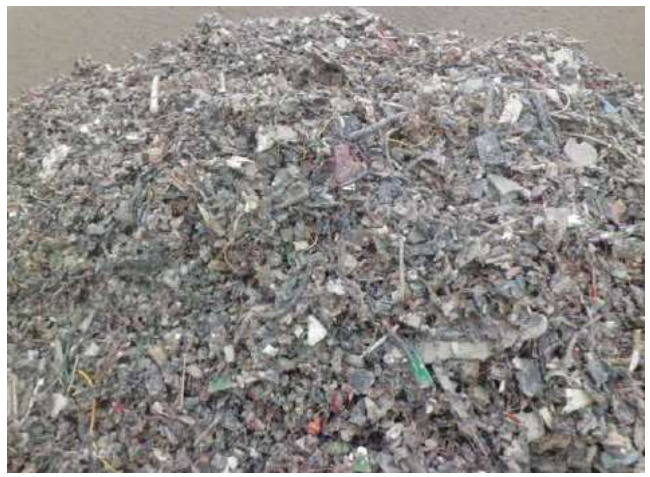
図 3-29 除去された重質ダストの様子
