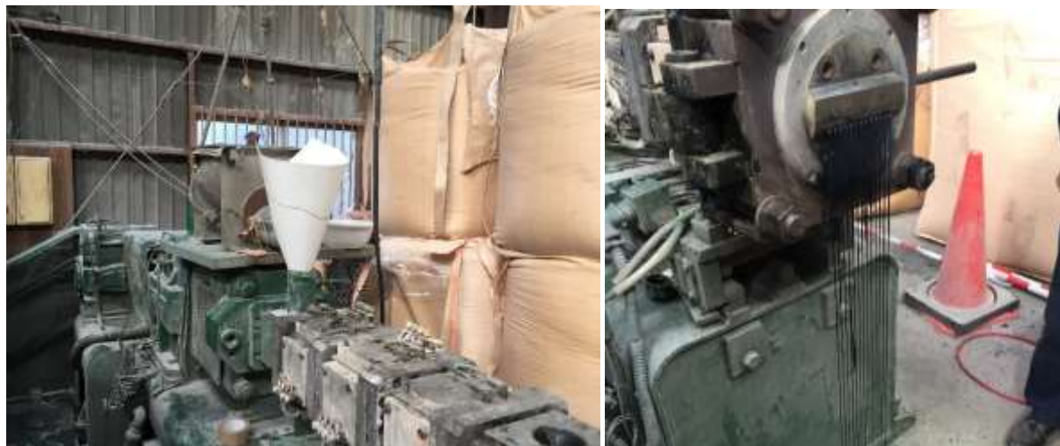
図 4-1 二軸の押出機を活用したコンパウンドコンパウンド試験の様子
