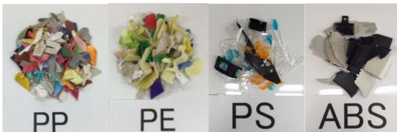
図 2-32 FT-IR 等で選別されたミックスプラスチックの一例
