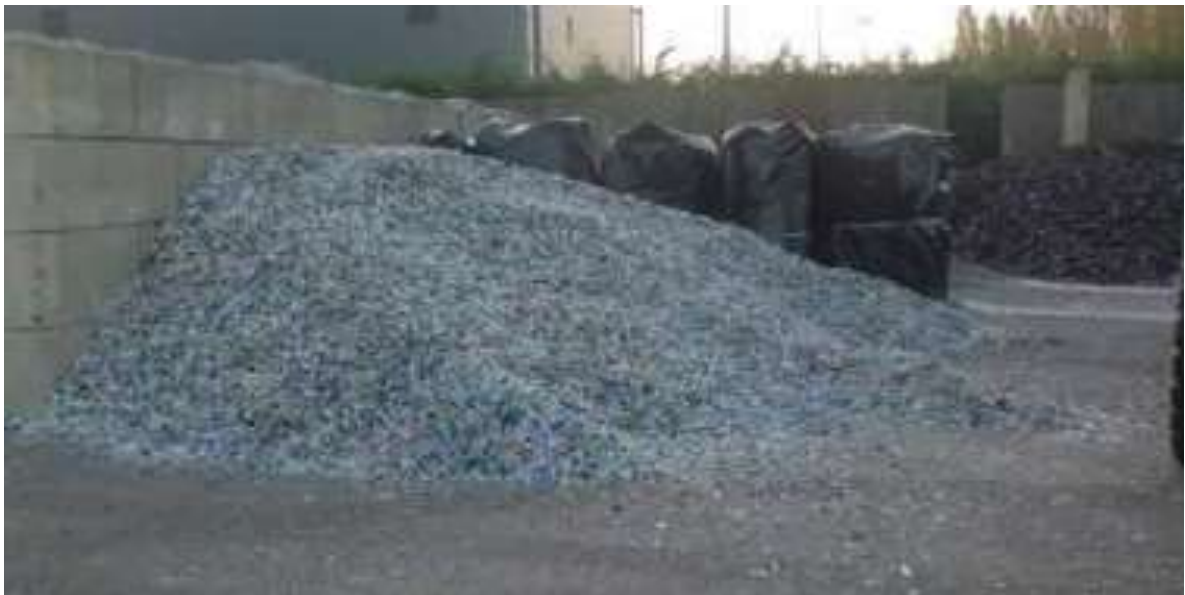
図 3-39 搬入された秋田エコプラッシュ(株)の製品プラスチックの破砕物 (ストックヤード)
