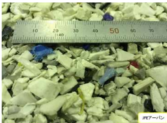
図 3-50 家電 4 品目由来ミックスプラスチックからの主成分が PP である選別物
