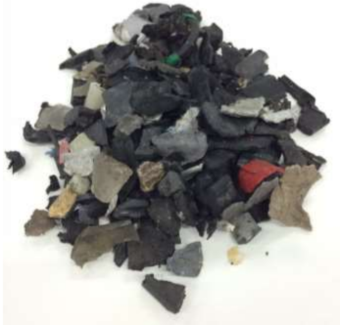
図 2-8 サンプリングされた ASR 由来のミックスプラスチック (注：ASR から鉄、非鉄、ウレタン等を除去したミックスプラスチック)
