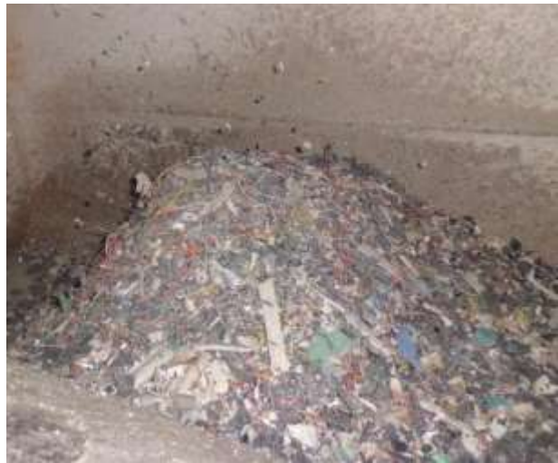
図 3-15 除去された重質ダスト
