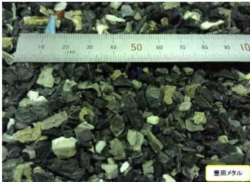
図 3-49 ASR 由来プラスチックからの主成分が PP である選別物
