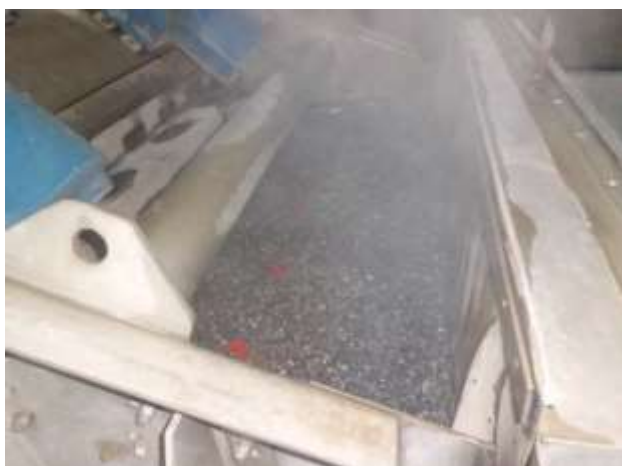
図 3-4 粉砕機への投入の様子
