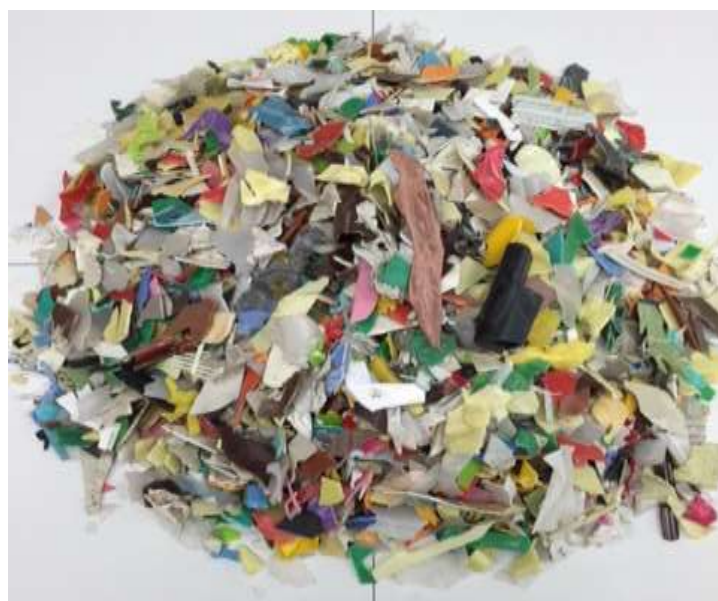
図 2-18 サンプリングされた製品プラスチック等の破砕物 (注：製品プラスチックを破砕したミックスプラスチック)
