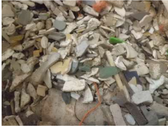
図 3-13 搬入された JFE アーバンリサイクル(株)の家電 4 品目由来のミックスプラスチック
