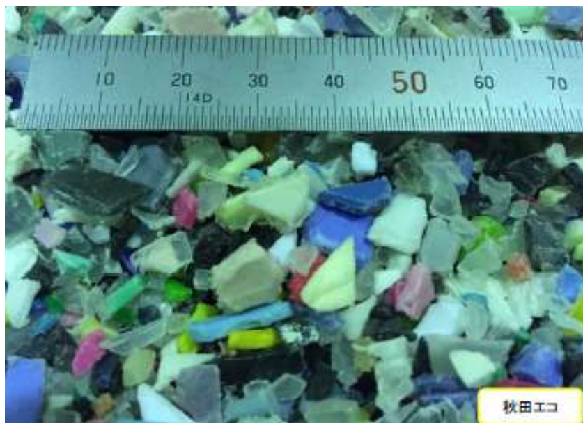
図 3-52 製品プラスチックからの主成分が PP である選別物
