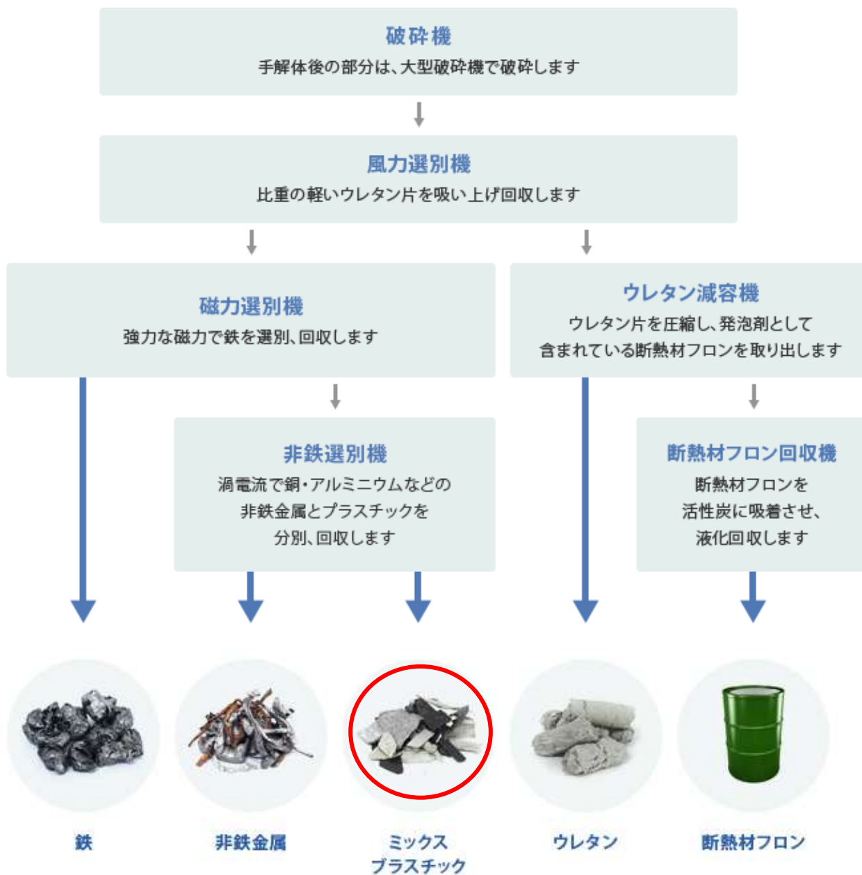
図 2-9 JFE アーバンリサイクル(株)におけるミックスプラスチックの回収プロセス
