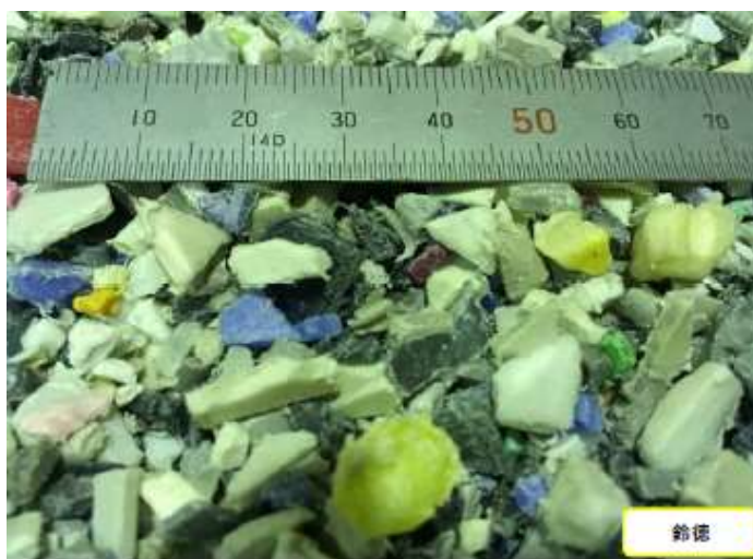
図 3-51 小型家電由来ミックスプラスチックからの主成分が PP である選別物
