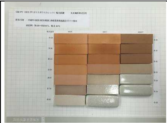
GMPV-MIX-MIX-HRK 配合焼成品
