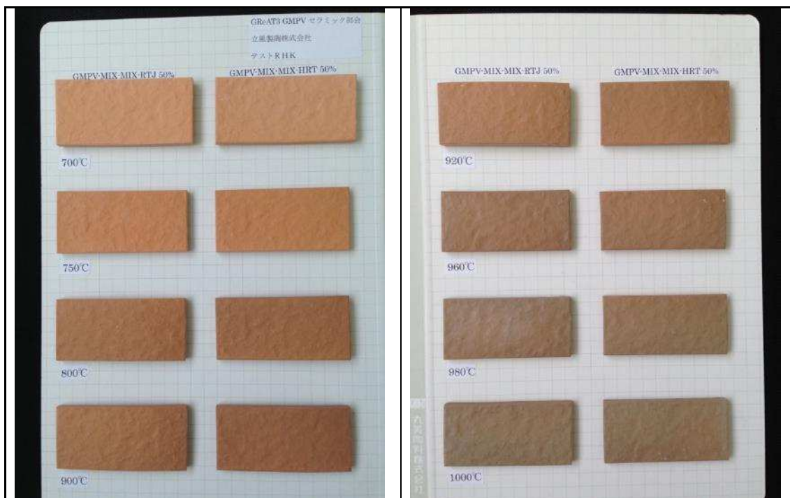
最適焼成温度の確認テスト
