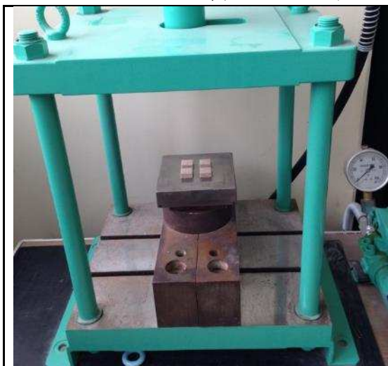
写真 5 : テスト手動プレス ガラスモザイクのプレス
