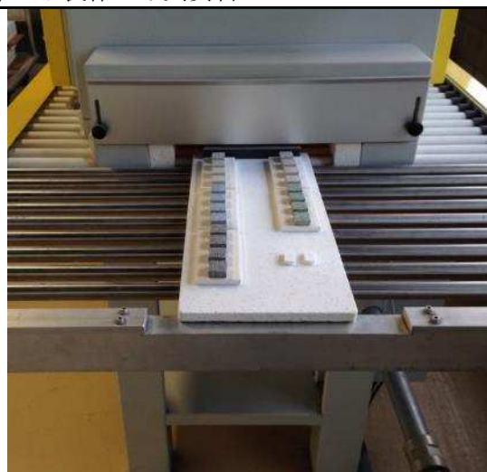
写真 6 : ガラスモザイク焼成 テスト RHK 入口
