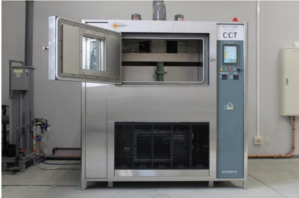
図 61.3 CCT 試験機外観写真
