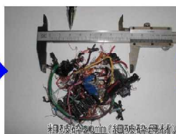
粗破碎処理 粗破碎20mm(細破碎母材)
