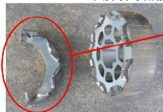
トヨタアクアでの作業の様子(磁石取り出し失敗)
