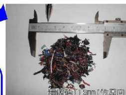
② ラフチョッパー処理 細破碎1.3mm(竹炭用)
