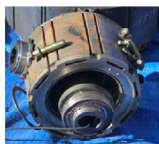
消磁前 強力な磁力のため、ネジなどがくっついている。
