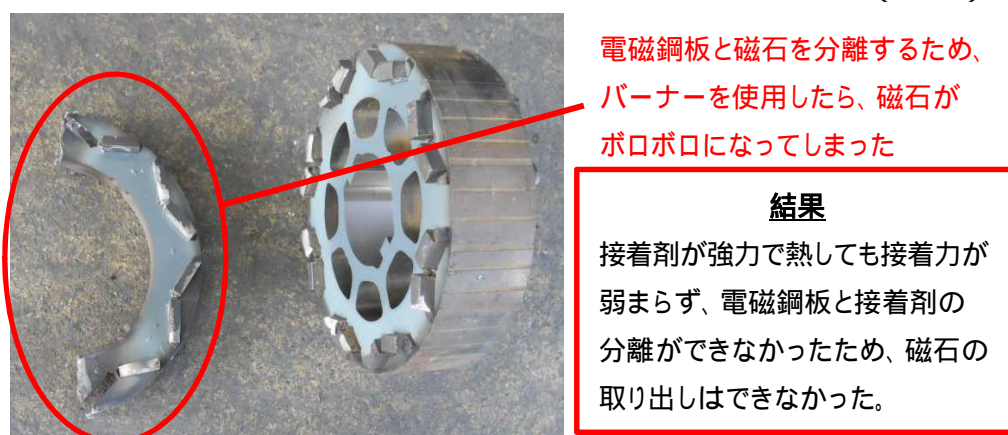
図表 4-11 トヨタアクアでの作業の様子：磁石取り出し失敗（再掲）
