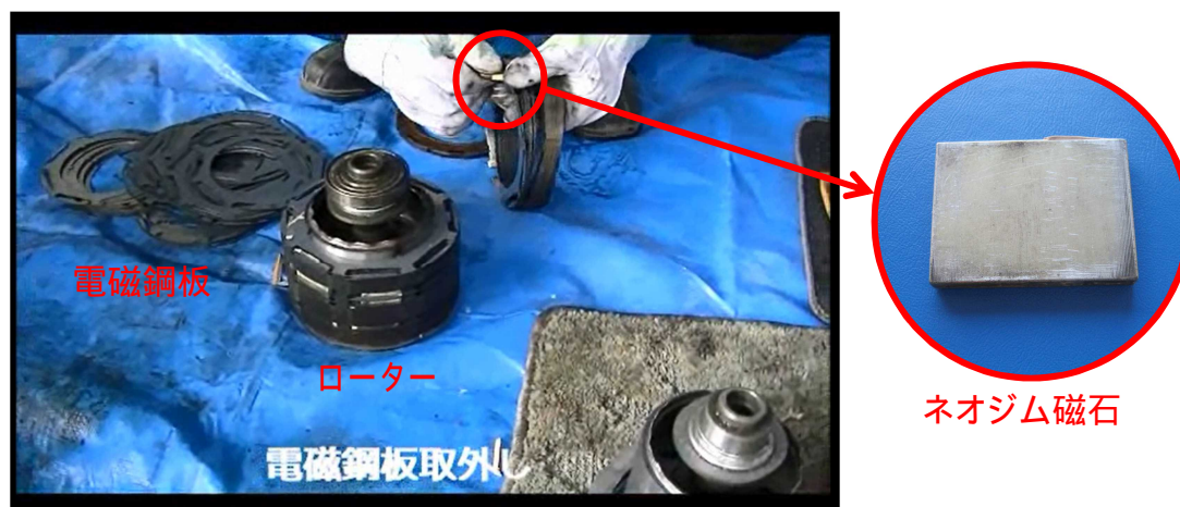
図表 7-1 ローターを電磁鋼板と磁石に分解する作業の様子
