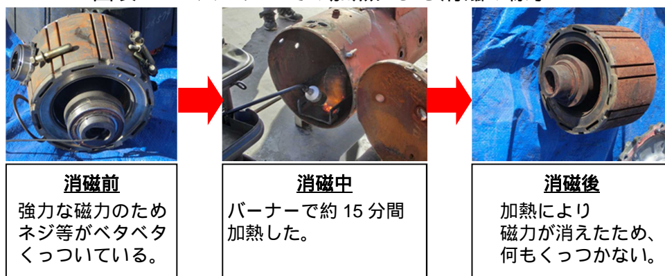
図表 4-1 バーナーでの加熱による消磁の様子
