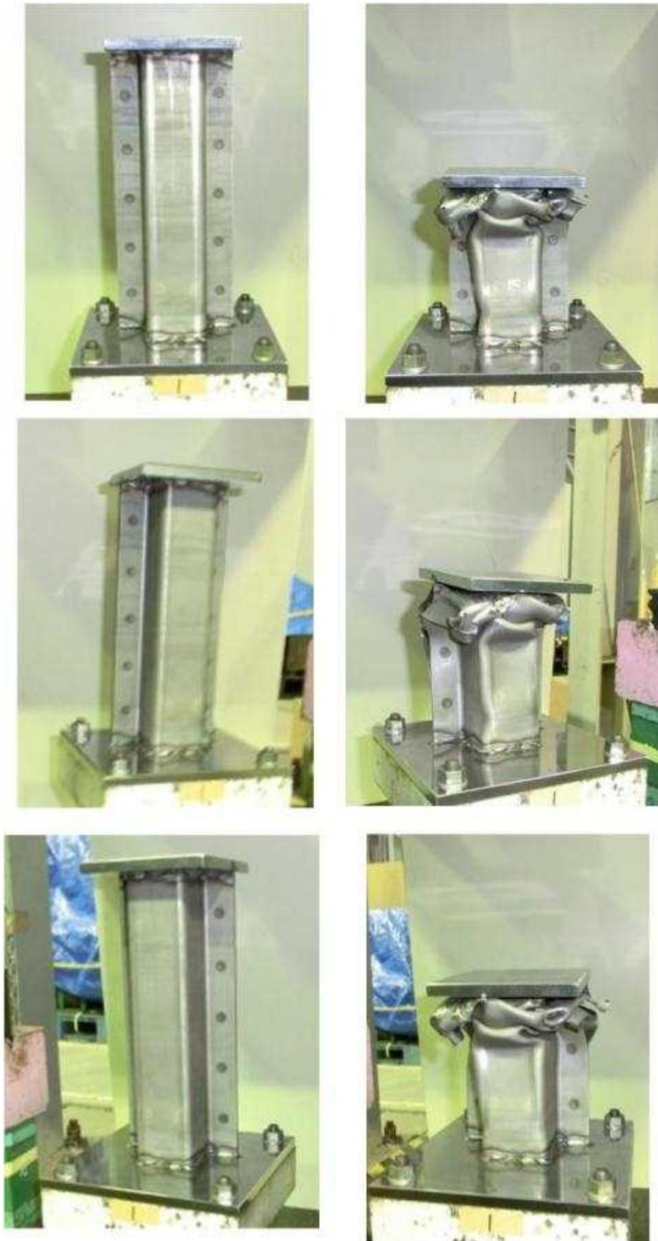
図 7.55 試験前後の部材外観写真(No.1)
