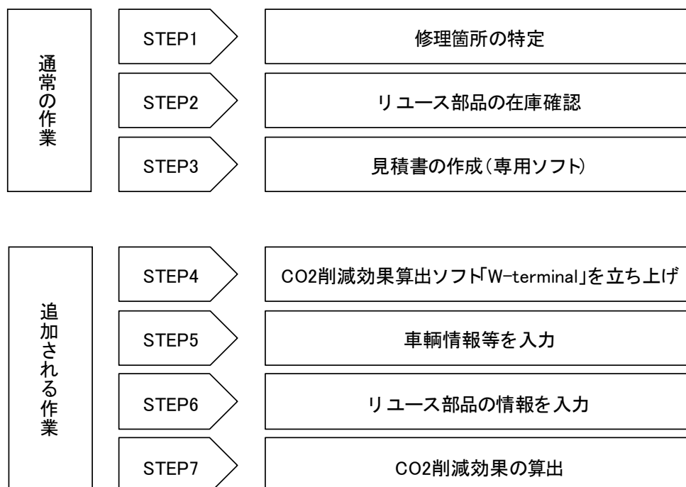
図 4-3 整備工場で発生する追加作業
