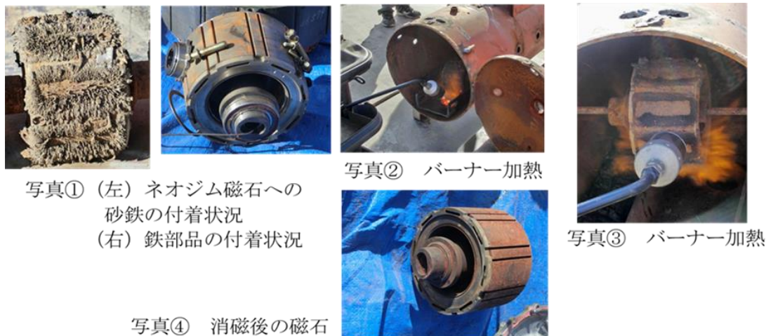
図 3.42 HV 車のエンジン、モーターの解体状況
