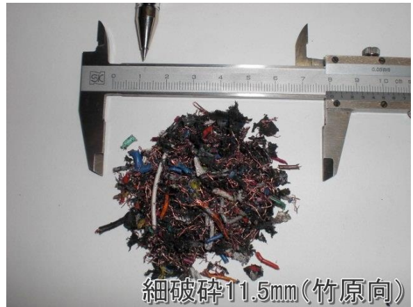
図 3.34 ラフチョッパー処理フローの処理物
