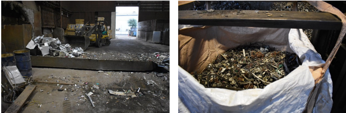
図表 24 小型家電の破砕機投入と発生産物
