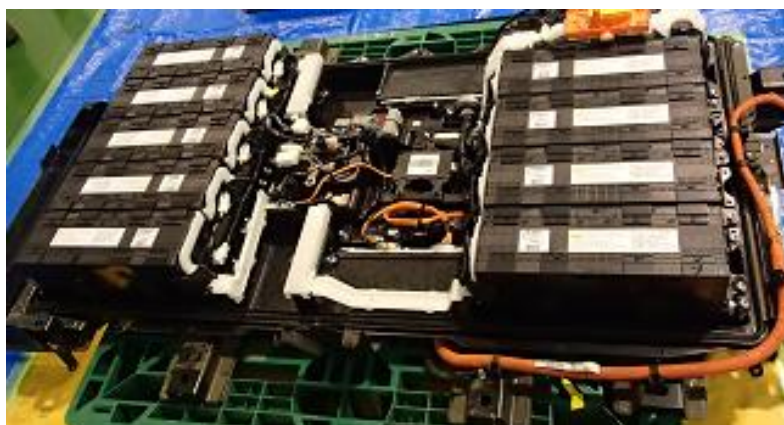
図 10 アイミーブのユニット（上部の蓋を取り外した状態） 291 kg
