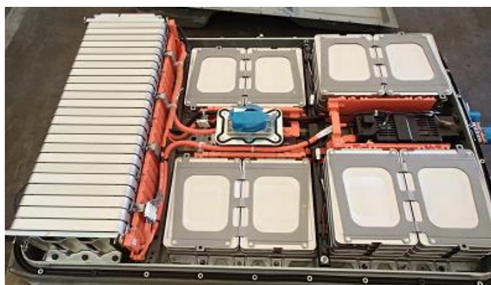
図 9 リーフのユニット（上部の蓋を取り外した状態）291.0 kg
