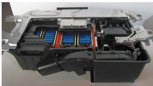
図 11 フィットのユニット 28.4 kg
