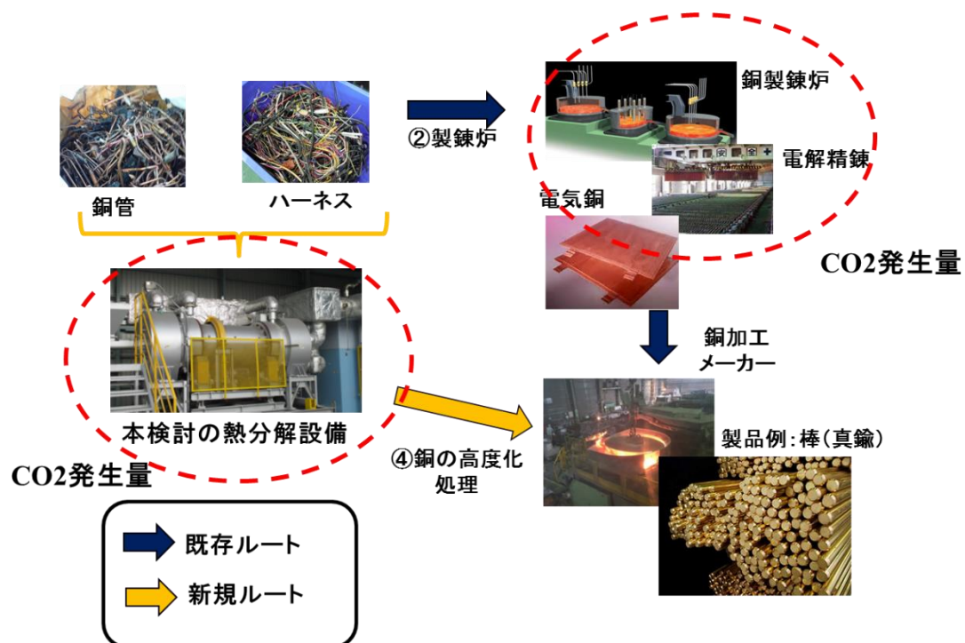
図3 銅の高度化処理におけるCO 2 発生量の考え方
