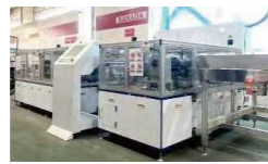
太陽光パネルリサイクル設備
