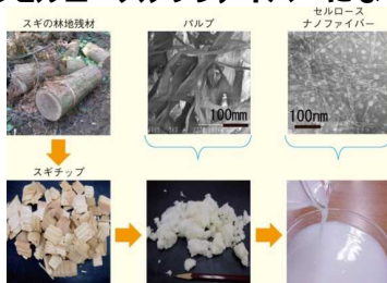
【木材からセルロースナノファイバーになるまでの過程】
