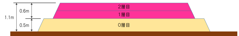
盛土イメージ(改質材・改良材添加土の施工性確認試験)
