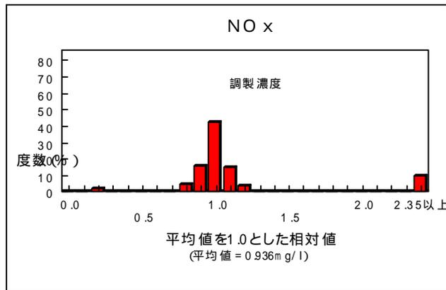
図1 排ガス吸収液試料のヒストグラム
