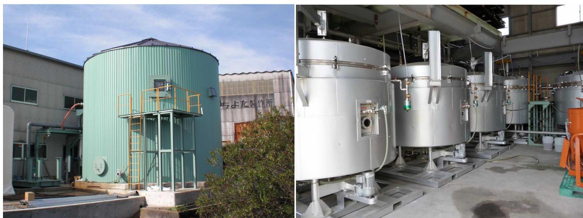
図 3-60 メタン発酵槽（左）とバイオエタノール製造装置（右） 出所）（株）ちよだ製作所
