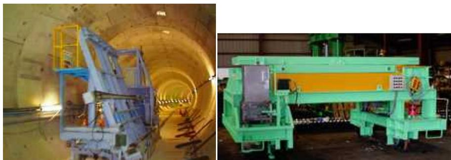
図 3-62 「共同溝仕切壁設置作業車」、「共同溝仕切壁受台設置作業車」イメージ
