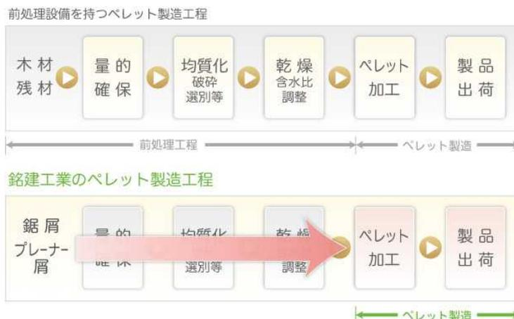
図 3-56 銘建工業のペレット生産プロセス 出所) 銘建工業 (株)
