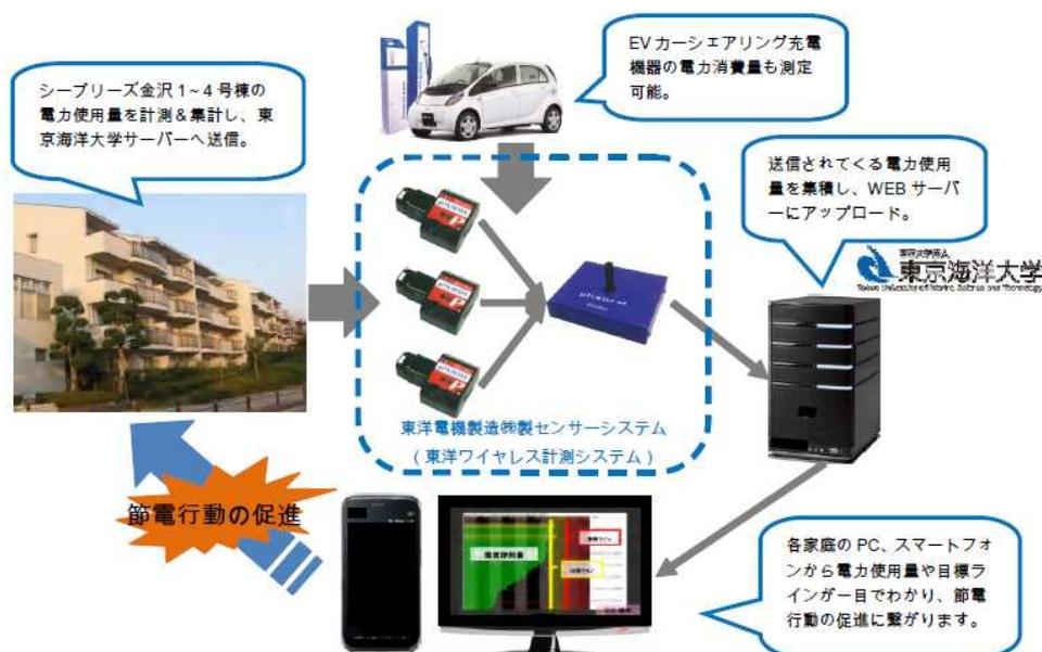
図 3-44 電力見える化システムイメージ 出所) (株)オアシスソリューション
