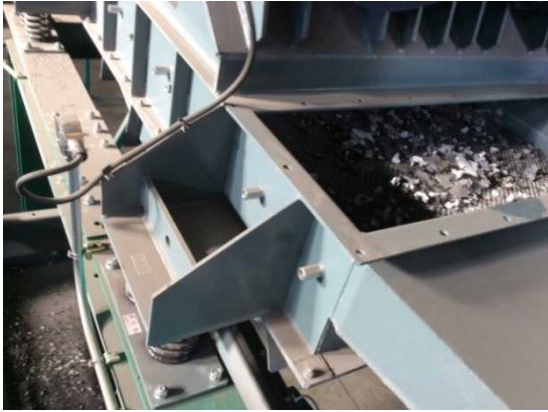
図 1-12 ふるいで残った 8mm 程度の屑
