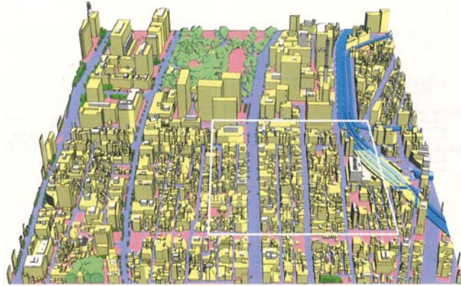
図2 数値計算に用いたモデル街区(新橋) ※図中の白枠は計算領域の500m四方を示す。
