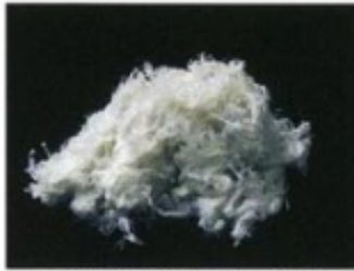
白石綿(クリソタイル)
