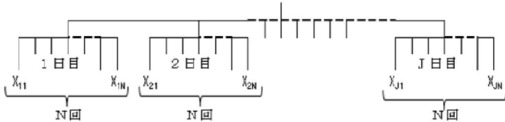
(2) 一日当たりの試験回数、実験計画日数及び実験計画に従って分析を行い得られた測定値を用いて、一元配置の分散分析による解析を行い、試験法の評価に必要な併行精度及び室内精度を算出する。
