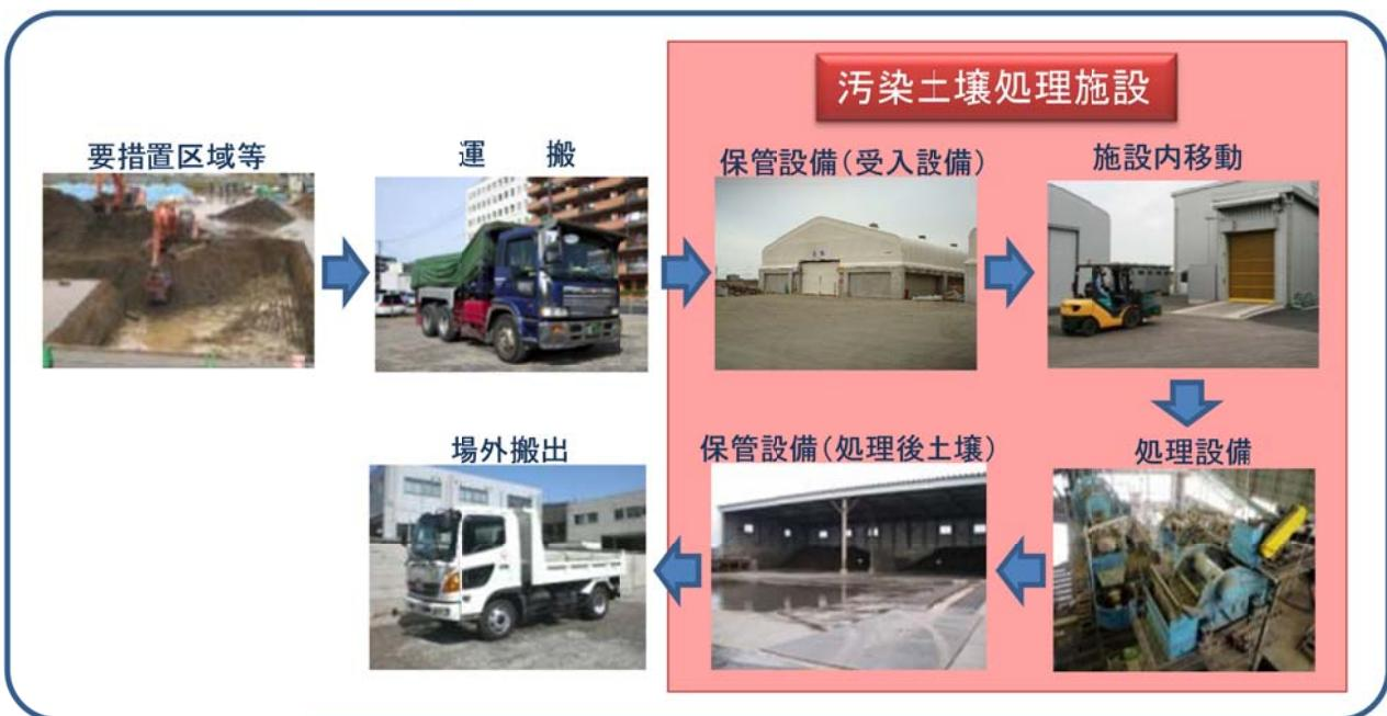
図 2.1.2-2 汚染土壤処理施設における一連の作業の例
