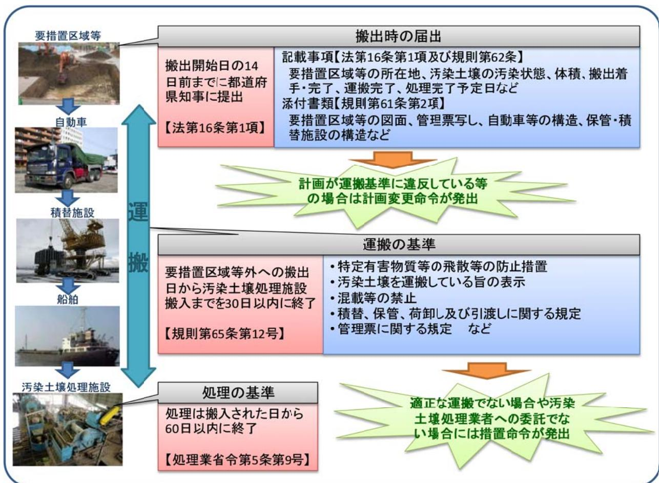
図1.5.2-1 要措置区域等から搬出される汚染土壤の運搬の概要
