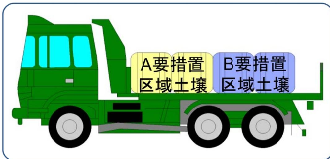
図 3.5.2-1 要措置区域等ごとに区分して運搬する方法の例（フレキシブルコンテナ）
