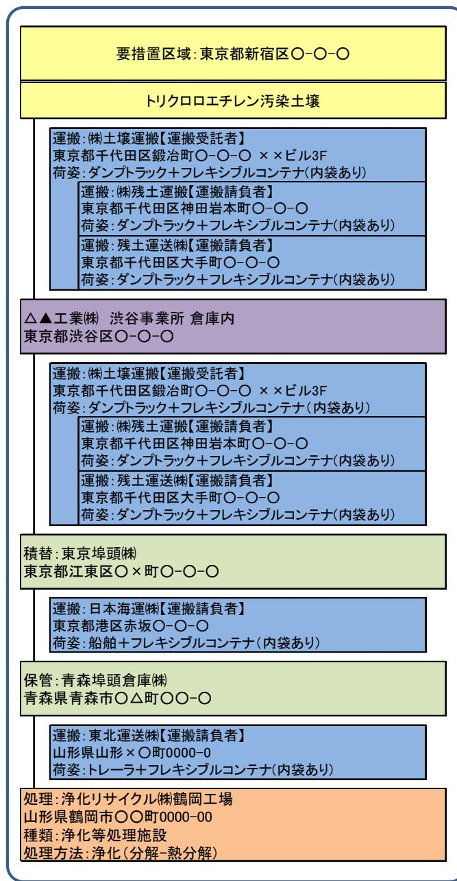
図 2.3.1-2 運搬フロー図の記載例
