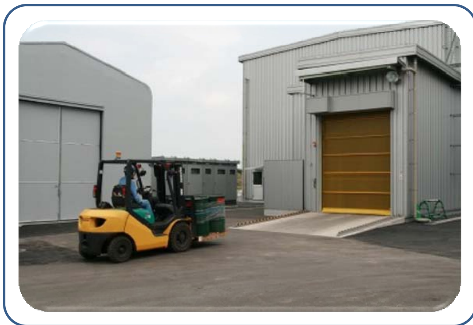
図 2.3-2 飛散防止措置が講じられた施設内移動の例（ドラム缶）
