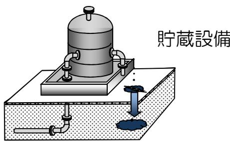
◆平成13年、輸送用機械器具製造工場で、トリクロロエチレンの貯蔵タンクへの移し替え作業による地下水汚染が判明
