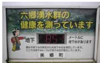
写真：地下水位掲示板
