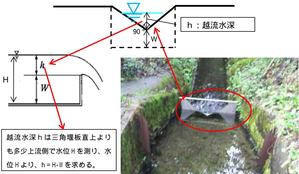
図3-6 三角堰法の計測イメージ
