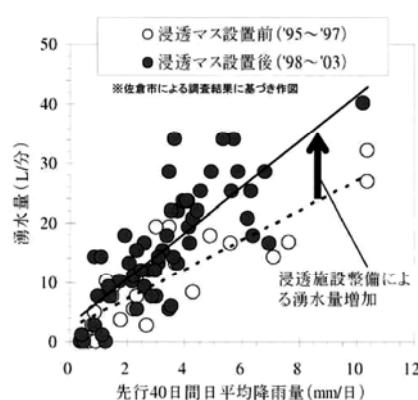
図：浸透施設整備による湧水量の増加
