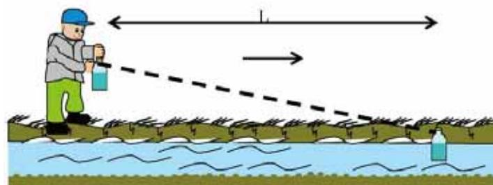
図 3 - 5 水路流速断面計測法の計測イメージ
