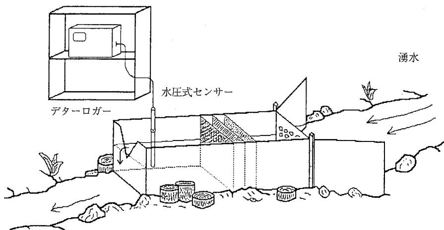
図3-3 漩水量測定のための直角三角堰の設置概念図（寸法は表3-2参照）
