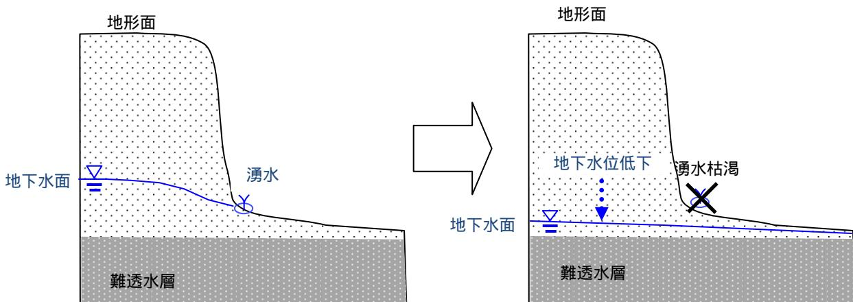
図 2 - 2 地下水位低下に伴う湧水の枯渇を示す模式図
