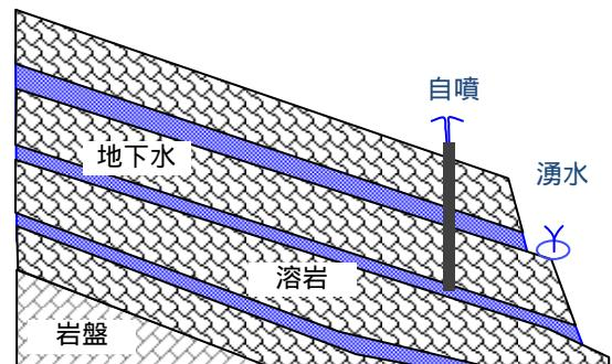
(b) 亀裂中の裂か水の例
