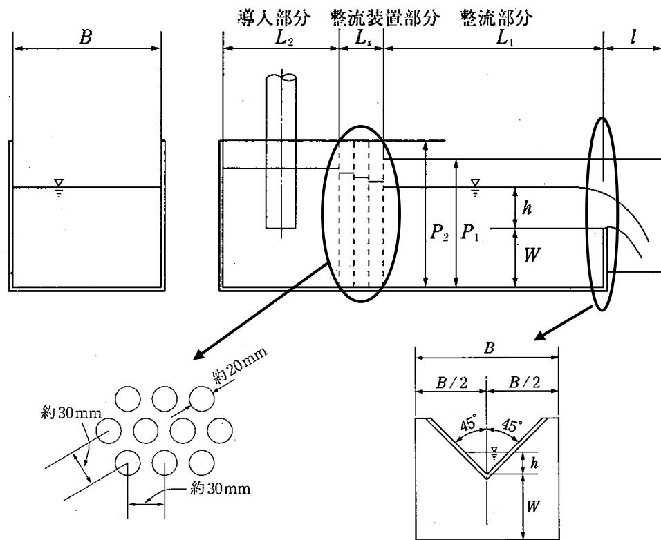
図3-2 直角三角堰の構造（寸法は表1-2参照）
