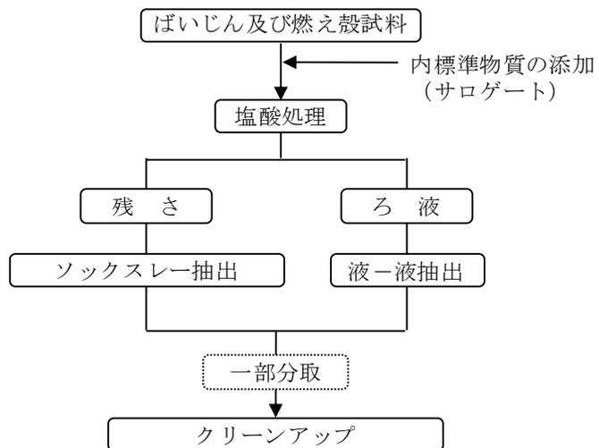
図-4 ばいじん及び燃え殻試料の抽出操作フローの例
