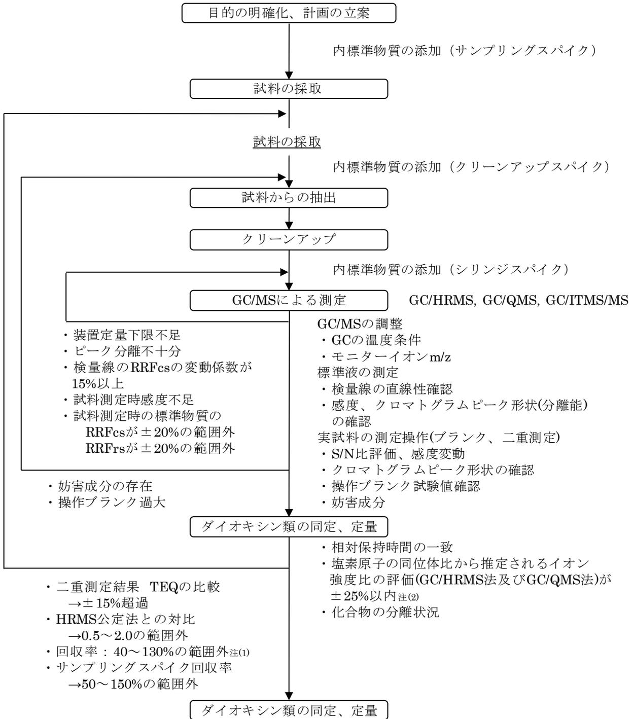
図-1. 試料の採取から測定の流れ
