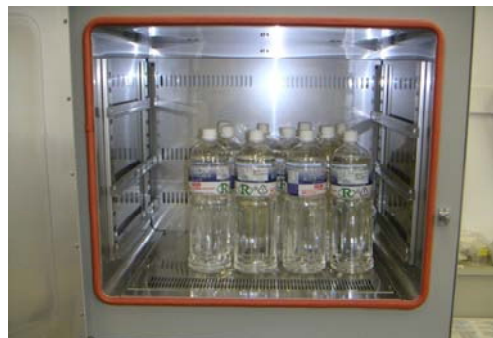
図1. 0.1wt%代理汚染物質水溶液を用いたPETボトルの汚染実験（40℃で14日間保温）
