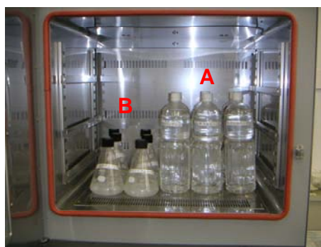
図3. 純水、50%エタノール溶液、4%酢酸溶液を用いた溶出実験（49℃で30日間保温）
