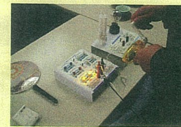
LED・電球比較実験器の赤と黒の端子に手回し発電器の赤と黒の端子をつなぐ
