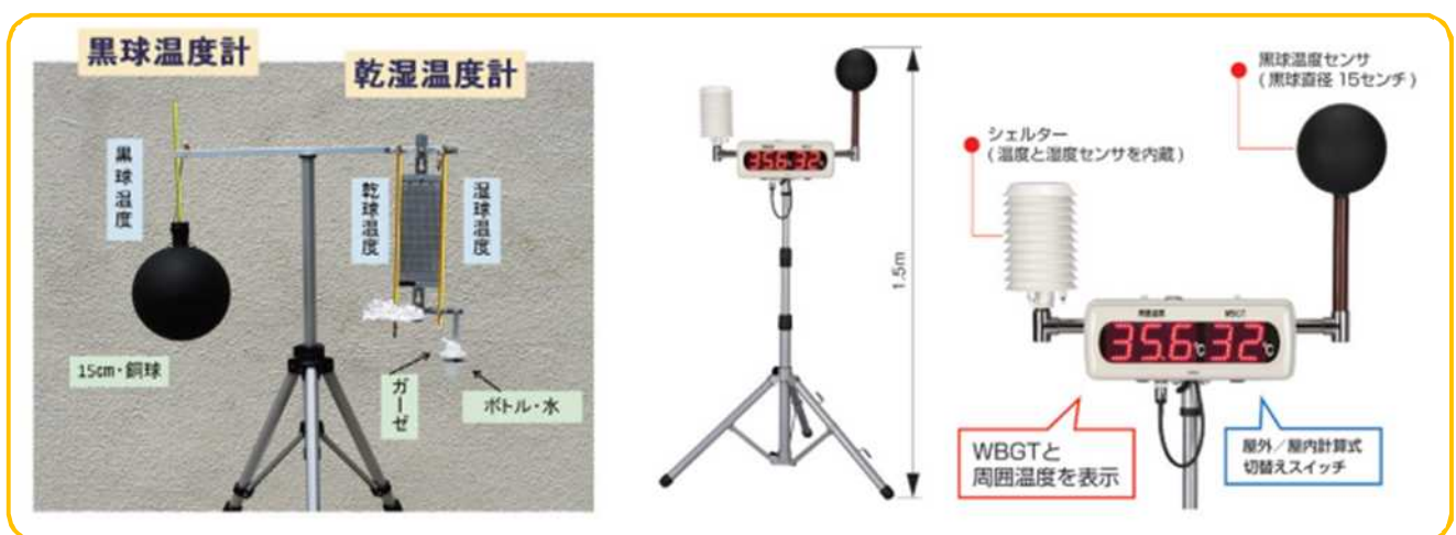
図 2-24 暑さ指数 (WBGT) 測定装置 左は基本型、右は電子式のもの（出典：環境省 29 ）
