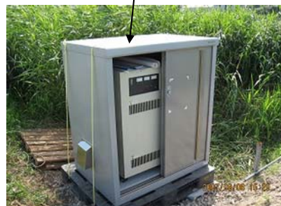
図5 水塊外に置かれたオゾン発生装置
