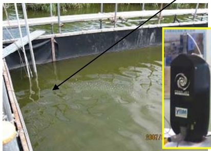
図4 溶解装置を設置した隔離水塊
