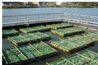
図-2 隔離水塊に設置した処理装置浮島
