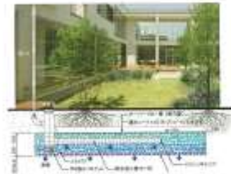
図7-3 レインガーデン機能を備えたガーデン(概念図) レインガーデン機能を備えたガーデン(図)は、雨水貯留浸透基盤に雨水を貯留・浸透させる構造。
