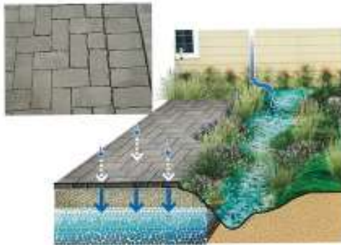
図6-4 J・ミックスを使った雨水貯留浸透基盤の構造（断面図を拡大し、詳しくは図6-5を参照）
