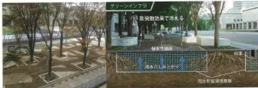
図2-1 グランモール公園の断面構造概略図 敷設された保水性舗装（左）から入った雨水は、雨水貯留浸透装置を介して地表までしみ上がり、保水性舗装に貯留される。雨水貯留インフラからの蒸散、樹木の蒸散作用を通じて、気候調節効果が期待される。
