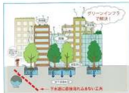
図6-1 雨の中でも、雨水は地中にしみこませる工夫が必要。(概念図) 雨も物中としこませて、下水道に負担をかけない工夫がグリーンインフラの概念
