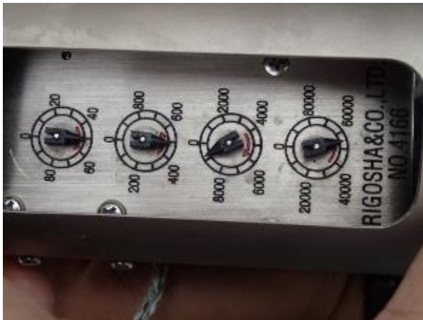
Flow meter (RIGO.No.5571)
