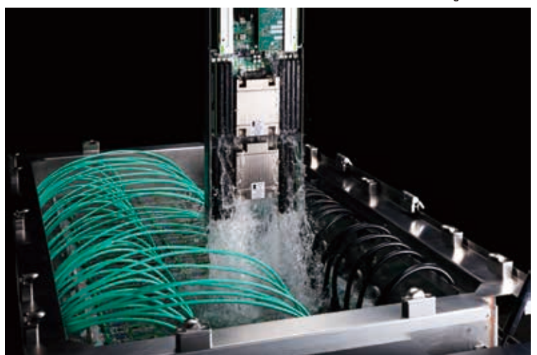
液浸冷却システムによるCO 2 排出削減
