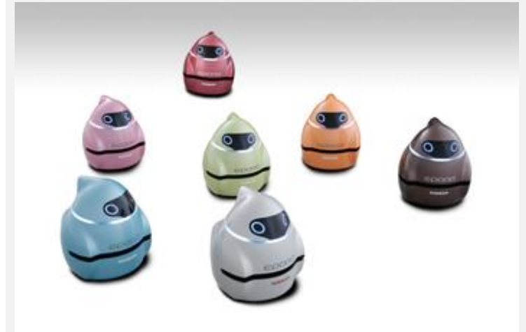
魚群の動きを模倣したロボットカー「EPORO」 出所)日産自動車株式会社
