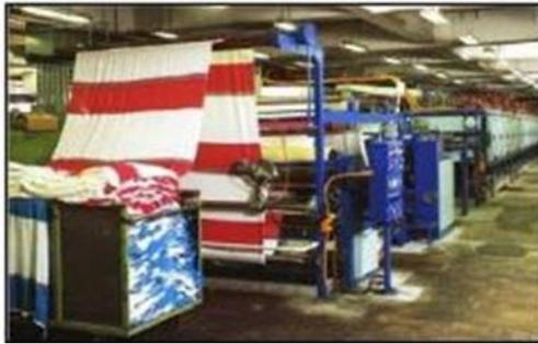
中国の繊維染色工場で性能のモデル実証試験を実施中の高効率テント（生地仕上げ乾燥設備）
