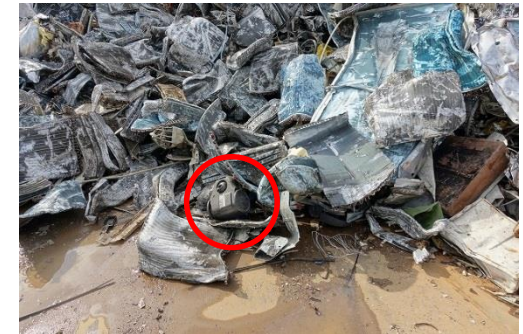
掃除機が混入
